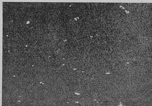
Rys. 8. Pokryta miedzią powierzchnia cynku. Zanieczyszczenia Pb i Fe dają jasne punkty (x 100).
