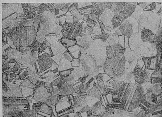
Rys. 4. Struktura mosiądzu polerowanego i trawionego metodą chemiczną (x 100).
