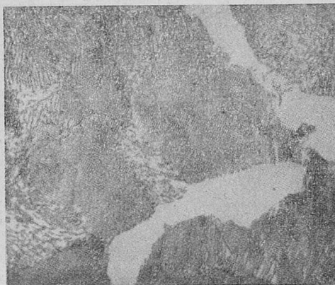
Rys. 2b. Struktura stali w tym samym miejscu próbki jak a uzyskana po kilkakrotnym polerowaniu i trawieniu (wg Vilellia ) ( \times 700 )
