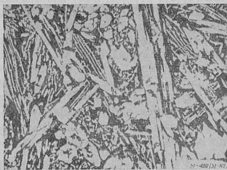
Rys. 5. Mikrostruktura napoiny wykonanej gazowo stopem stellitopodobnym Bail 3. Grube iglaste węgliki w osnowie ledeburytycznej (powiększenie 150 X).
