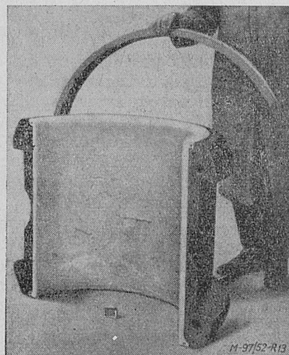
Rys. 13. Wielkości łożysk wlewanych stopem Cu-Pb.
