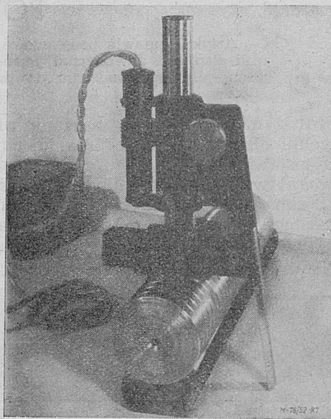
Rys. 7. Gładkościomierz Biernawskiego typ WB-4.
