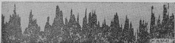
Rys. 1. Profil powierzchni szlifowanej uzyskany metodą skośnego szlif.
