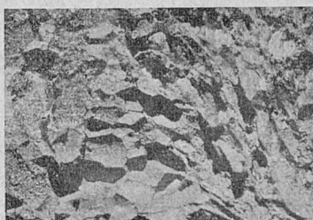
Fot. 2. Przełom stali przegrzanej aż do początku nadpalenia. Pow. około 10 \times \Phi .
