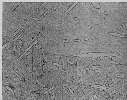
Fot. 21. Brąz glinowy, hartowany przy temperaturze, w której istnieją jeszcze dwie fazy (dwa układy krystaliczne): faza alfa i beta. Pow. 200\times\Phi .
