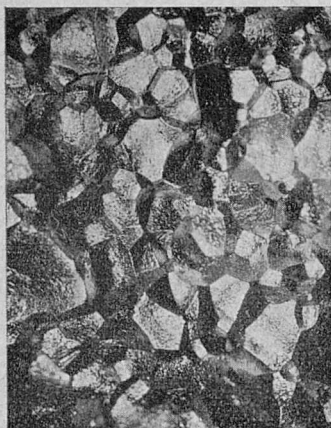
Fot. 1. Przełom kawałka brązu glinowego wybitnie gruboziarnistego. Pow. około 8 \times \Phi .
