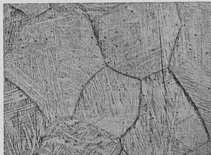
Fot. 19. Ziarna fazy „beta” w zahartowanym brązie glinowym (89% Cu + 11% Al). Pow. 200\times\Phi .
