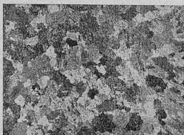
Fot. 7. Wielkość ziarna w stopie glinu. Próbką wytrawioną kwasem fluorowodorowym. Pow. 15 \times \Phi .
