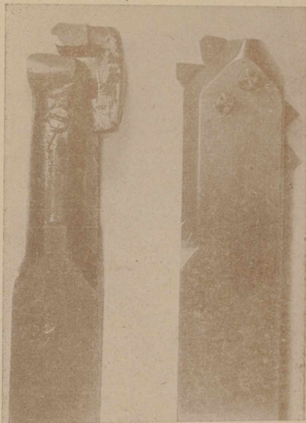
Noże do wytaczania: opracowany przez racjonalizatora M. Prasza oraz ulepszony przez IOOS
