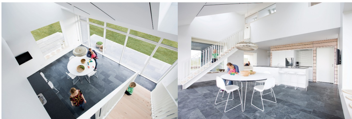
RYСУNEK 2.3.6, rys. 8–9. Zdjęcia ze strefy wspólnej. Otwarta przestrzeń i wysoko umieszczone okna wspomagają wentylację naturalną. Ciemna posadzka podnosi wydajność pozyskiwania energii słonecznej z promieni bezpośrednio na nią padających.
