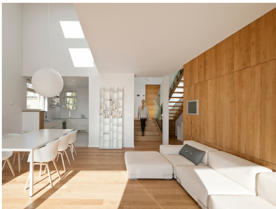
RYSUNEK 2.3.9, rys. 4. Widok na poziomie parteru. Nad strefą jadalni pustka powietrzna pozwalająca na swobodniejszy przepływ powietrza przez budynek przy stosowaniu wentylacji naturalnej.
