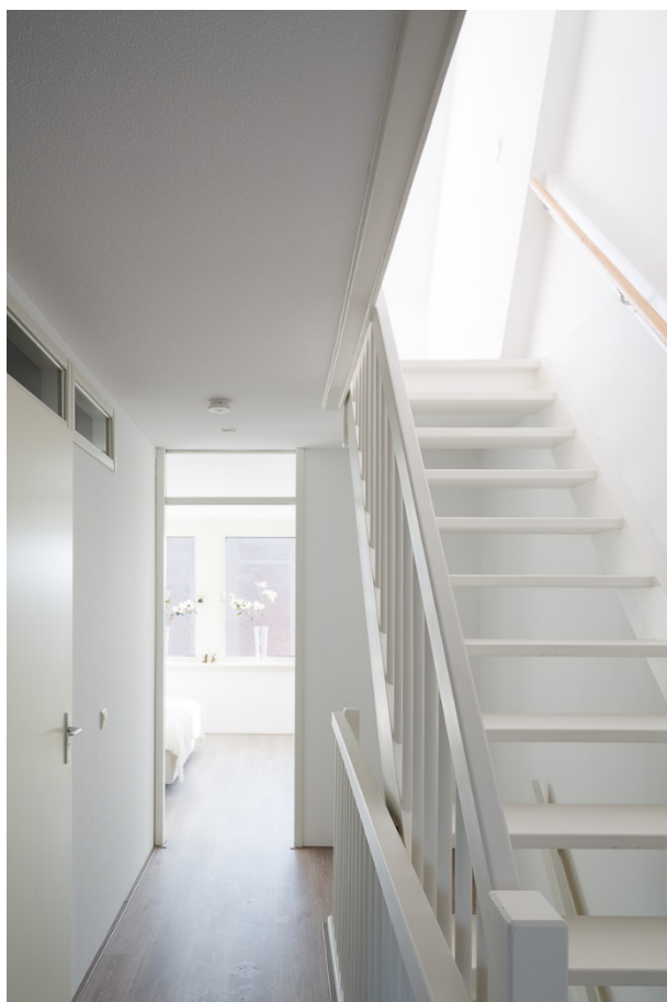
RYSUNEK 2.3.11, rys. 7. Wnętrze z widocznym doświetleniem przez okna na połaci wschodniej i zachodniej. Jasne kolory wykończenia pozwalają na osiągnięcie lepszego wskaźnika oświetlenia światłem dziennym.
