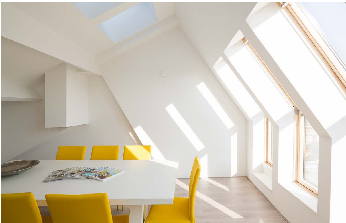
RYSUNEK 2.3.11, rys. 7. Wnętrze z widocznym doświetleniem przez okna na połaci wschodniej i zachodniej. Jasne kolory wykończenia pozwalają na osiągnięcie lepszego wskaźnika oświetlenia światłem dziennym.
