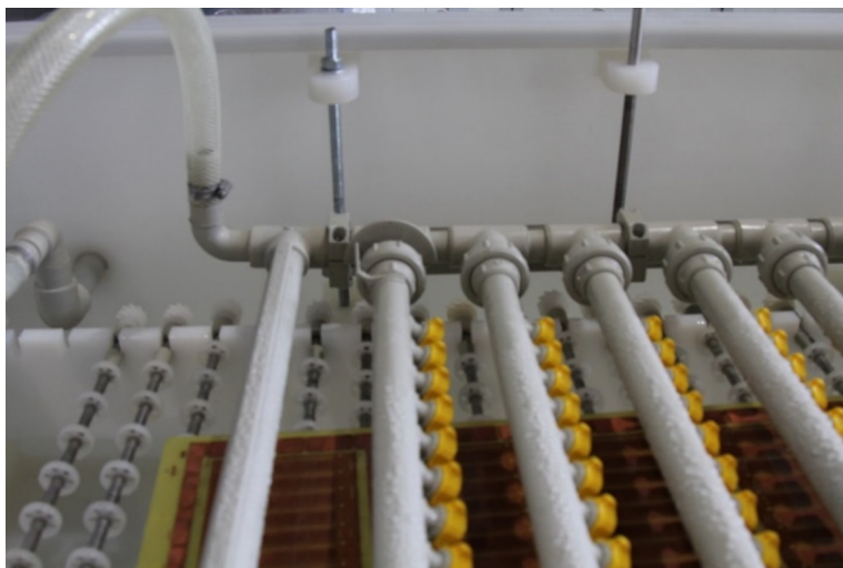
Rys. 3.54. Wariant II transportu fluidalnego – regulowane dysze natryskowe i układ zasilający
