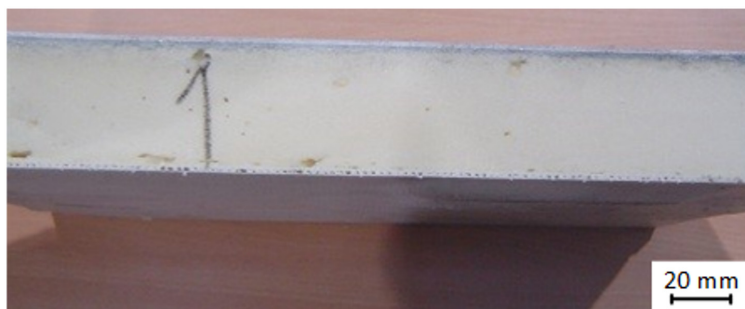
Rys. 2.8. Płyta kompozytowa wycięta mechanicznie z obudowy chłodziarki
