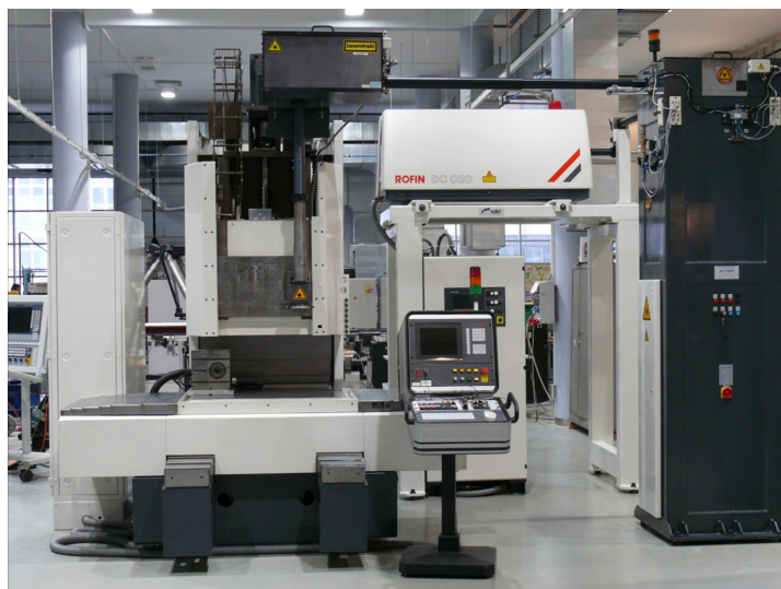
Rys. 2.9. Stanowisko badawcze do laserowego przecinania kompozytów warstwowych
