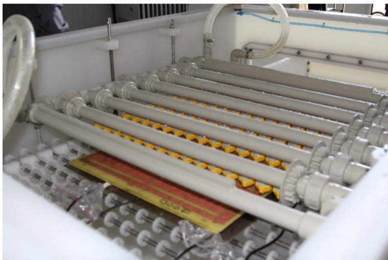
Rys. 3.55. Układ pomiarowy na stanowisku testowym z czujnikami siły do badania wariantu II transportu fluidalnego
