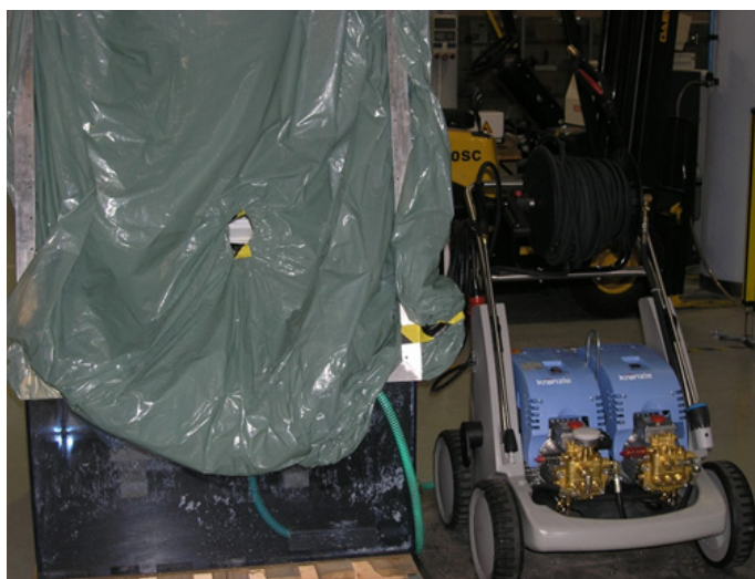
Rys. 3.61. Stanowisko badawcze do prób oczyszczania, wyposażone w urządzenie firmy Kränzle
