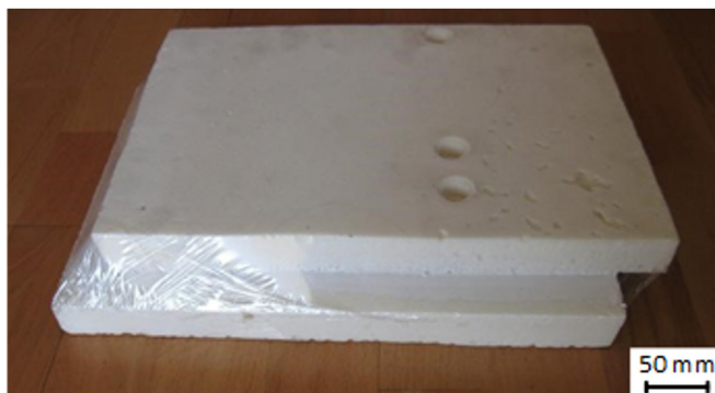
Rys. 2.67. Obkurczanie folią polietylenową sklejonych paneli z pianki PUR
