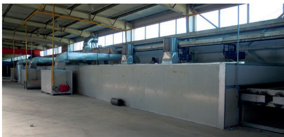
Rys. 2.35. Piec końcowego wypalania płyt włóknisto-cementowych: z przodu (po lewej), z boku (po prawej); fot. T. Gorzelańczyk
