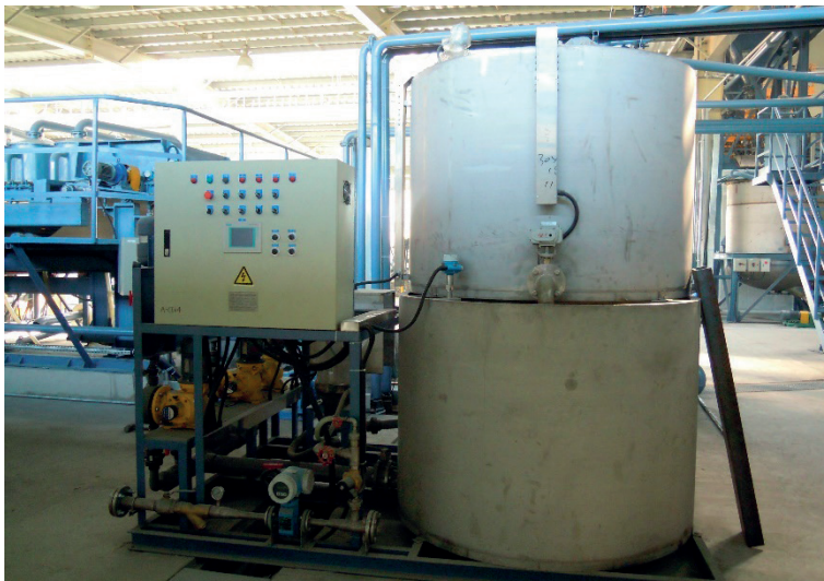
Rys. 2.21. Mikser z urządzeniem do pomiaru gęstości płynnej masy; fot. T. Gorzelańczyk
