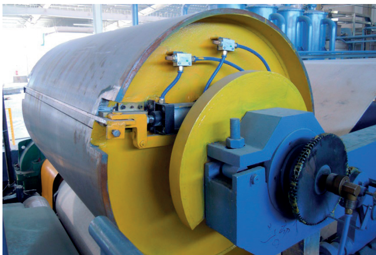
Rys. 2.26. Bęben formujący maszyny flow-on; fot. T. Gorzelańczyk
