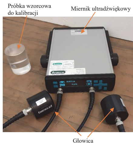
Rys. 2.41. Przykładowy miernik ultradźwiękowy
