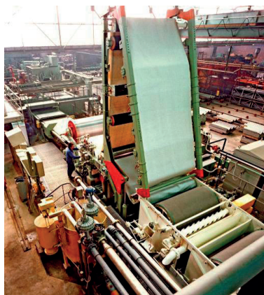
Rys. 2.22. Maszyna Hatscheka w trakcie konserwacji [191]
