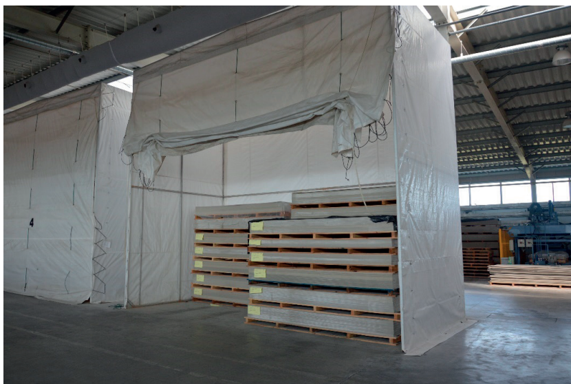
Rys. 2.34. Zaprojektowana komora klimatyczna do pielęgnacji płyt włóknisto-cementowych podczas ich dojrzewania; fot. T. Gorzelańczyk
