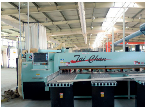
Rys. 2.37. Urządzenie do cięcia płyt włóknisto-cementowych na sucho; fot. T. Gorzelańczyk
