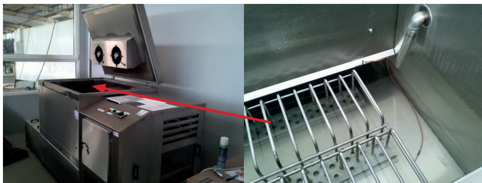
Rys. 2.4. Urządzenie do badania cyklicznego zamrażania-rozmrażania
