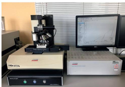
Rys. 4.49. Stanowisko do testów nanoindentacji (po lewej) oraz próbka przygotowana do testów (po prawej); fot. T. Gorzelańczyk
