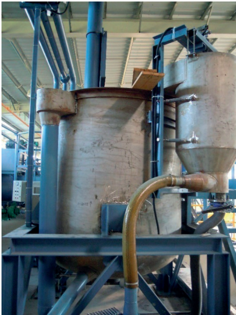
Rys. 2.19. Mieszalnik o pojemności około 5 m 3 ; fot. T. Gorzelańczyk
