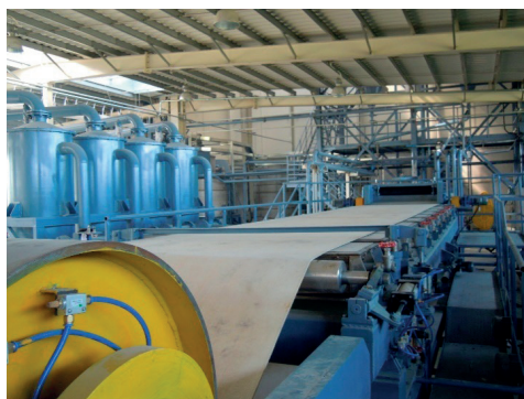
Rys. 2.24. Maszyna flow-on; fot. T. Gorzelańczyk
