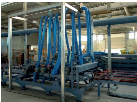
Rys. 2.36. Urządzenie do obróbki krawędzi płyt włóknisto-cementowych (po lewej), do szlifowania powierzchni płyt (po prawej); fot. T. Gorzelańczyk
