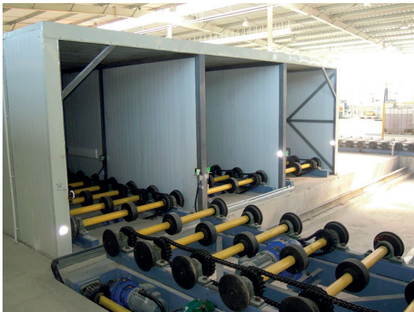
Rys. 2.33. Komora do obróbki cieplnej; fot. T. Gorzelańczyk
