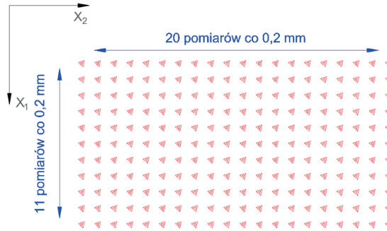
Rys. 4.50. Siatka pomiarowa do testów nanoindentacji
