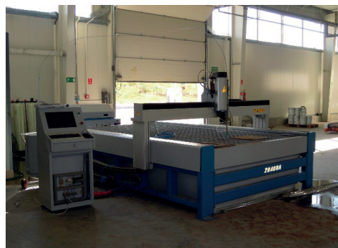
Rys. 2.38. Urządzenie do cięcia płyt włóknisto-cementowych na mokro ( water-jet ); fot. T. Gorzelańczyk
