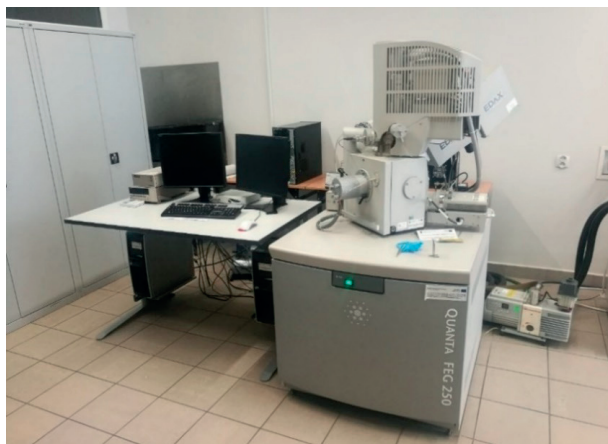
Rys. 2.57. Skaningowy mikroskop elektronowy z analizatorem EDS [2]
