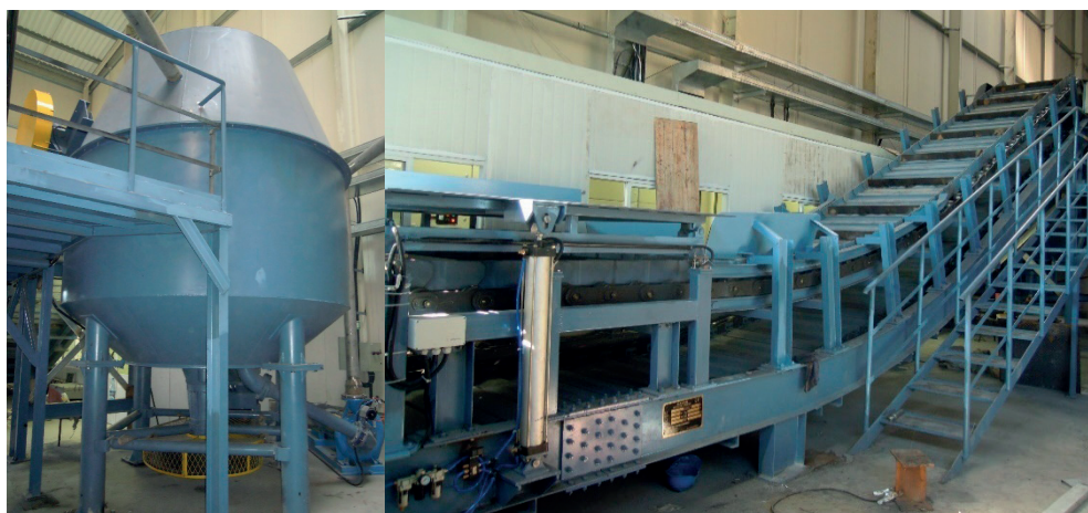
Rys. 2.16. Maszyna do rozcierania celulozy na miazgę – pulper (po lewej), przenośnik taśmowy do podawania celulozy (po prawej); fot. T. Gorzelańczyk
