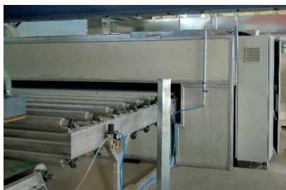
Rys. 2.35. Piec końcowego wypalania płyt włóknisto-cementowych: z przodu (po lewej), z boku (po prawej); fot. T. Gorzelańczyk
