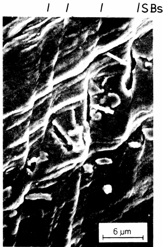
Rys. 6.1. Elektronografia (SEM) strefy MLO. Widoczne mikropęknięcia wzdłuż pasm ścinania SBs, odległych około 2,5 mm od czoła makropęknięcia. Stal 0,04% C, \epsilon_g = 64\% , \sigma_r = 156 MPa
