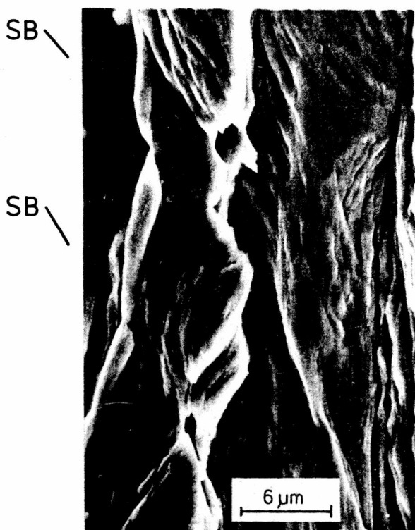
Rys. 6.9. Elektronografia (SEM) strefy MLO. Widoczny rozwój pękania w spłaszczonych ziarnach. Pękanie rozwija się wzdłuż mikroskopowych pasm ścinania SBs, zorientowanych skośnie względem kierunku cięcia.
