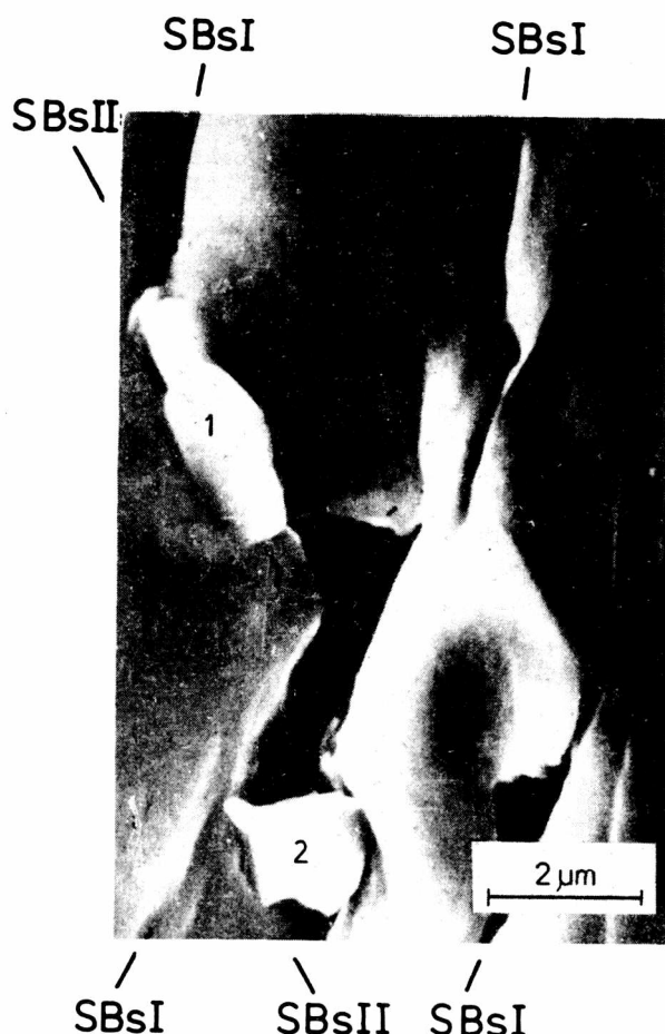
Rys. 5.16. Elektronografia (SEM) strefy MLO. Widoczny rozwój pęknięcia wzdłuż zasadniczych pasm ścinania SBsI, pod wpływem poprzecznych przemieszczeń materiału wzdłuż dodatkowego pasma ścinania SBsII: 1 i 2 - miejscowe ślady odkształceń, świadczące o blokowaniu przemieszczeń materiału po przejściu mikropasm MB (rys. 5.15) w pasma ścinania SBsI. Stal 0,04% C, \epsilon_g = 0 (powiększenie 10000 razy)
