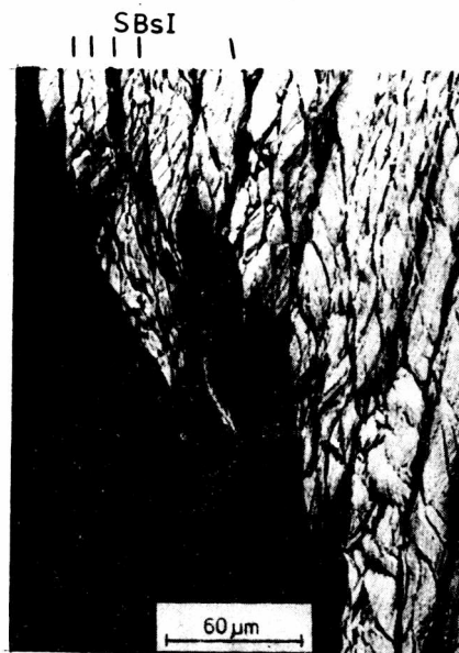
Rys. 5.18. Elektronografia (SEM) strefy MLO. Widoczne pasma ścinania SBsI na tle warstwowej budowy strefy MLO oraz związany z nimi profil przełomu. Stal 0,04% C, \epsilon_g = 84\%
