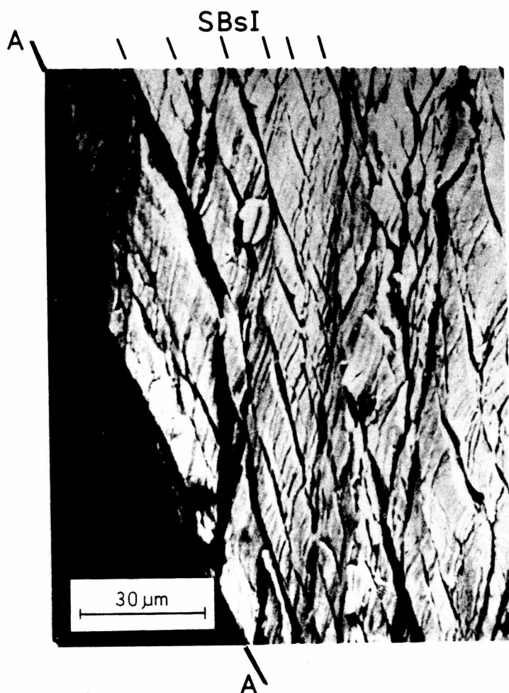
Rys. 5.12. Elektronografia (SEM) strefy MLO. Widoczny profil (A-A) przełomu oraz równoległe do niego pasma ścinania SBsI. Stal 0,04% C, \epsilon_g = 84\% Fig. 5.12. Electronography of zone MLS (SEM). Visible profile of the fracture and parallel to it shearing bands SBsI. Steel 0.04% C, \epsilon_g = 84\%
