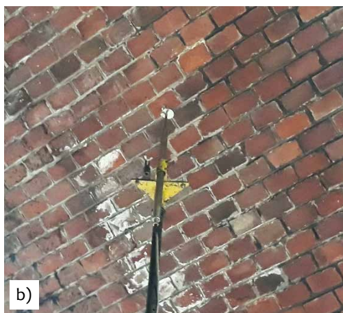
Rys. 5.35. Lokalizacja statywów z czujnikami pomiaru przemieszczeń sklepienia
