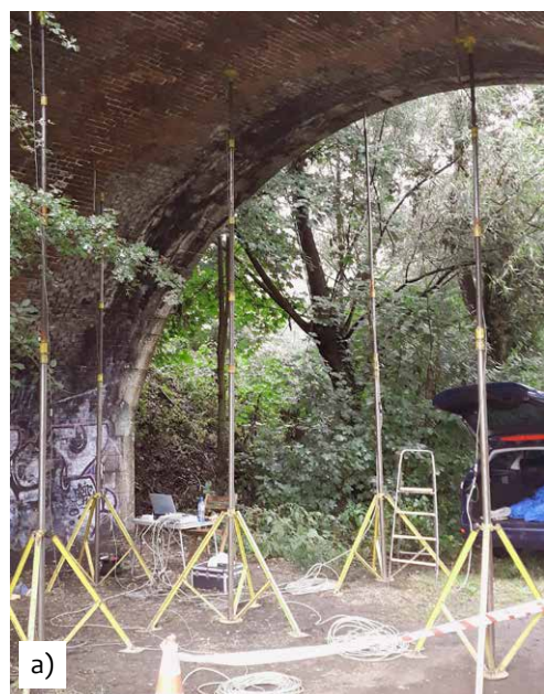
Rys. 5.35. Lokalizacja statywów z czujnikami pomiaru przemieszczeń sklepienia
