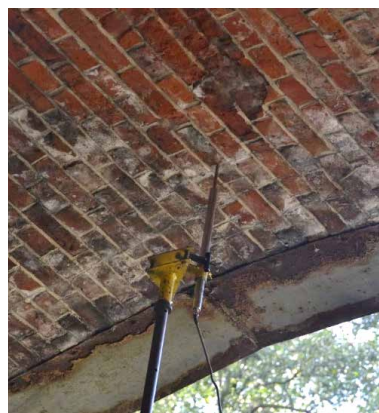
Rys. 5.26. Lokalizacja statywów z czujnikami pomiaru przemieszczeń sklepienia
