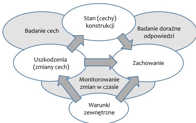
Rys. 5.1. Schematyczne przedstawienie idei wykorzystania badań w ocenie konstrukcji MMS i jej zachowania
