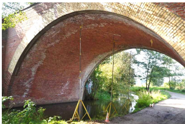
Rys. 5.26. Lokalizacja statywów z czujnikami pomiaru przemieszczeń sklepienia
