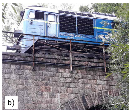
Rys. 5.9. Badania MMS pod obciążeniem statycznym balastem (a) [194] i ruchomym pojazdem (b)
