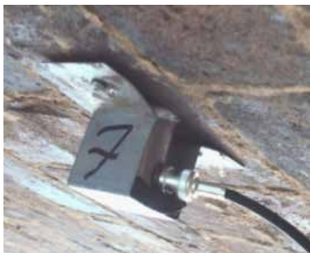
Rys. 5.8. Badanie metodą emisji akustycznej za pomocą czujnika przytwierdzonego do sklepienia [97]
