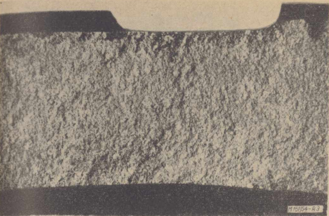
Rys. 3. Fragment przełomu freza NFTa 80 × 14 odlanego w formie płaskowej (powiększenie 8 ×)
