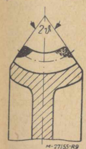
Rys. 9. Ścinanie wierzchołków zębów koła ślimakowego przy frezowaniu metodą promieniową.
