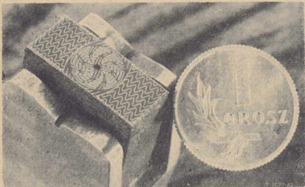
Rys. 3. Nowy typ końcówki do badania gładkości. Monetę umieszczono dla porównania wielkości.
