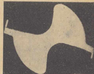
Rys. 4. Wąsy na profilu wiertła: a) ułożone poziomo do łysinki, b) ułożone prostopadłe do łysinki.
