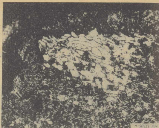
Rys. 14. Struktura ostrza pilnika (przekrój poprzeczny); widoczny ferryt pod cienką warstwą drobnoziarnistego martenzytu (niezeszlifowane odwęglanie przed hartowaniem).
