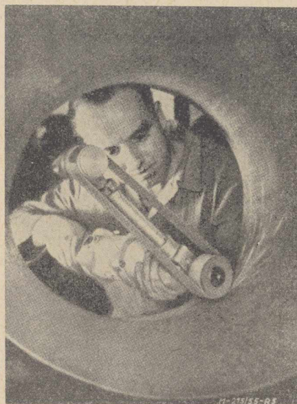
Rys. 5 — Praca szlifierki taśmowej
