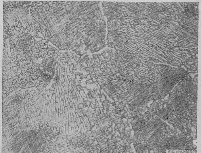
Rys. 3. Struktura wyjściowa stali N12E, pow. 1000 X.
