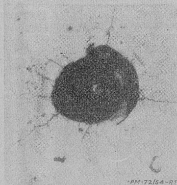
Odcisk Rockwella na węglkach spiekanych gatunku S1. Twardość 92 H_{RA} · 110 ×
