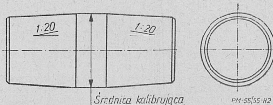
Rys. 2. Trzpień do wstępnego przetłaczania otworu.
