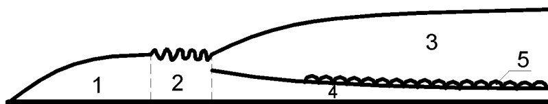
Rys. 3.1. Rozwinięcie warstwy granicznej: 1 – warstwa laminarna, 2 – obszar przejściowy, 3 – warstwa turbulentna, 4 – podwarstwa laminarna 5 – podwarstwa buforowa
