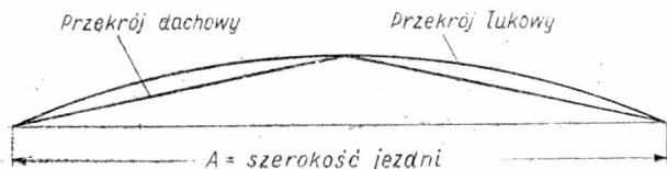
Rys. 1. Przekrój poprzeczny drogi
