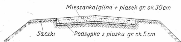
Rys. 7. Ulepszenie drogi gruntowej sposobem korytowym
