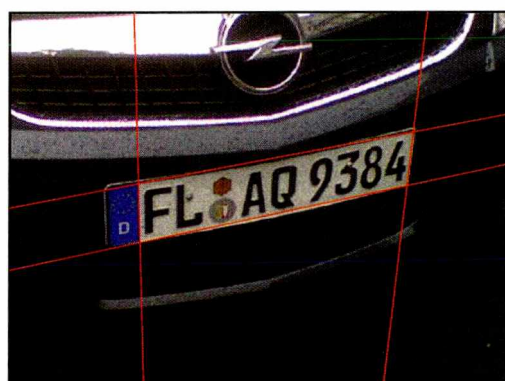
Rysunek 7. Obraz cyfrowy z usuniętym zniekształceniem perspektywicznym
