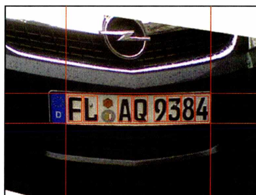
Rysunek 7. Obraz cyfrowy z usuniętym zniekształceniem perspektywicznym
