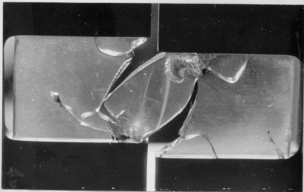
Rys.63 Próbka z epidianu 5 - widoczne trajektorie maksymalnych odkształceń postaciowych.
