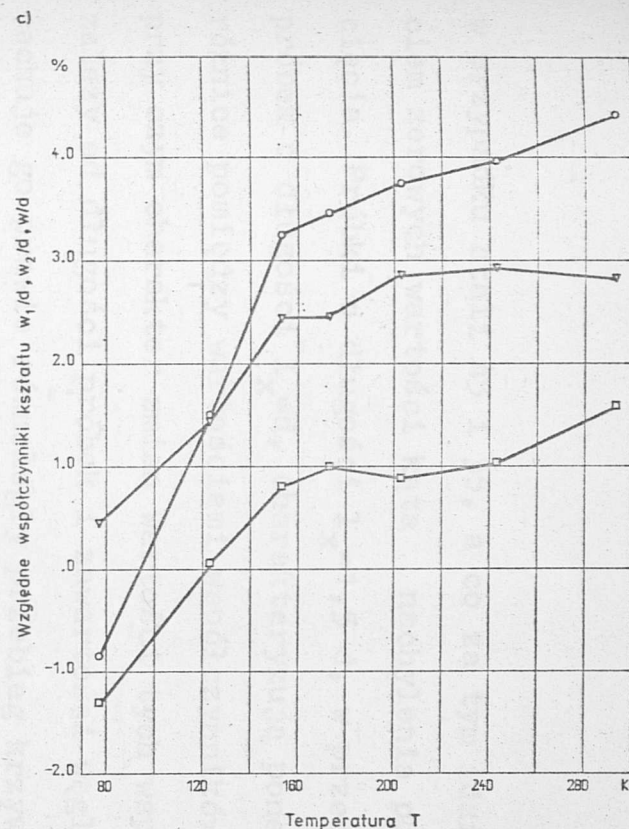
Rys.32. Wpływ temperatury T na wartość współczynników kształtu trajektorii pęknięcia: a-stal 10, b-stal 35, c-stal 45; \nabla - w_1/d -względna wklęsłość, \square -względna wypukłość, \circ - w/d -względna odległość ekstremalnych punktów trajektorii. Długość odcinanych próbek l_x/d = 1,5 . Szczelina tnąca L/d = 2,7\% .
