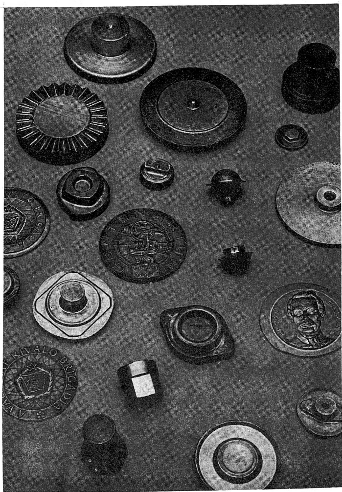
Rys. 9.3. Przykłady wyrobów produkowanych na prasie z wahającą matrycą
