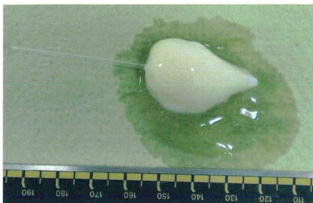
Rys. 62. Skoagulowana objętość po 20 minutach działania lasera o mocy 20W. Widok z zewnątrz (po lewej) i po przekrojeniu (po prawej).
