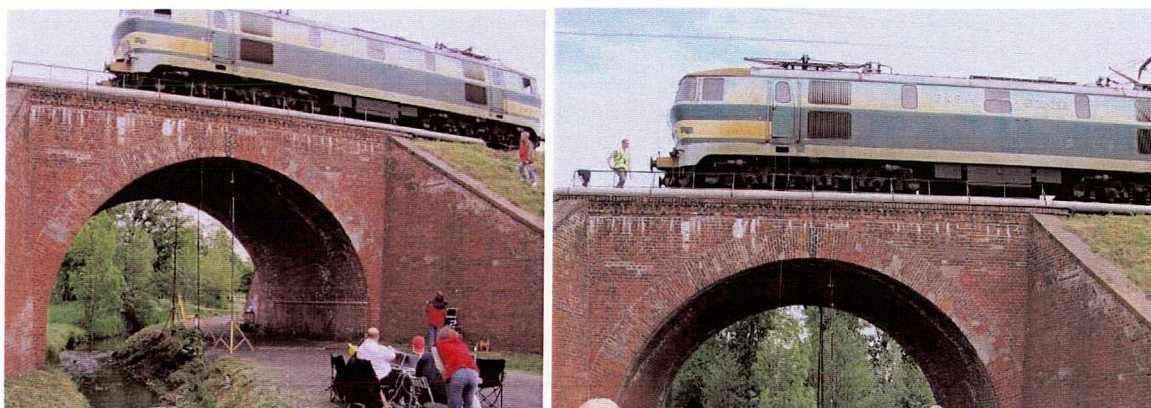
Rys. 3.49. Obciążenie mostu w Oleśnicy lokomotywą ET-22: a) schemat nr 1, b) schemat nr 2 (wg rys. 3.50)
