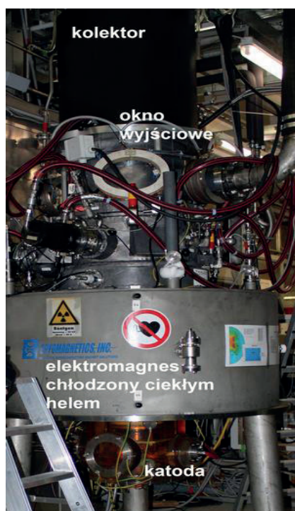
Rys. 2.17. Megawatowy żyrotron przeznaczony do fuzji jądrowej.
