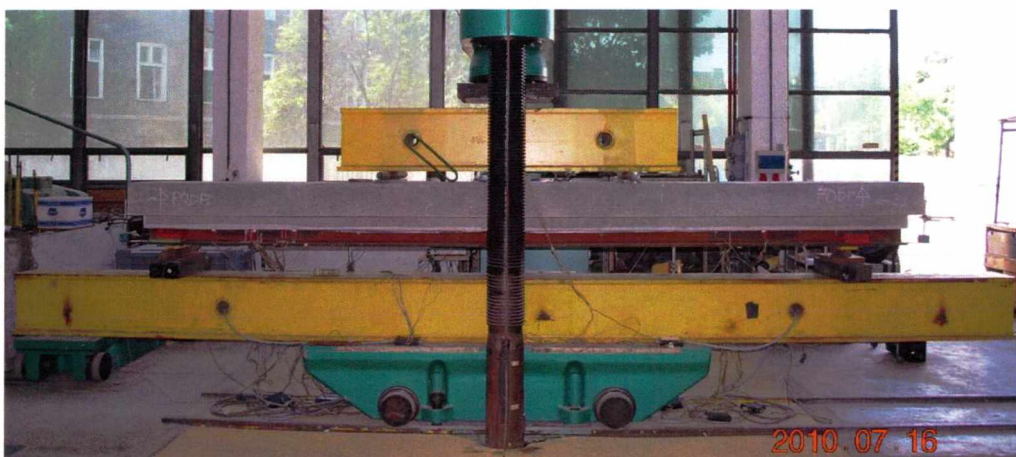
Rys. 4.49 Belka B1S-1 na stanowisku badawczym
