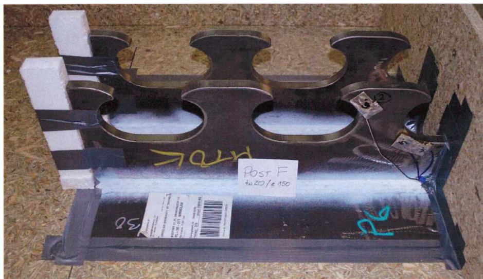
Rys. 4.9 Przyklejony styropian na powierzchni dolnej części stalowej na przykładzie POST F/2
