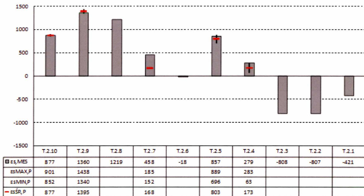
Rys. 5.22 Zbieżność wyników otrzymanych z modeli MES i doświadczenia dla łącznika nr 2 belki B2S-1
