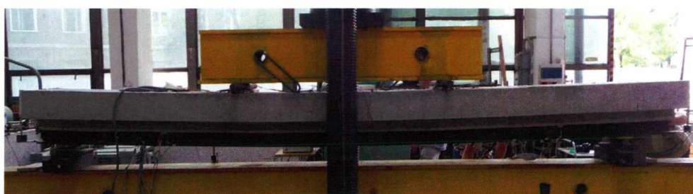
Rys. 4.57 Belka B1S-2 po zniszczeniu
