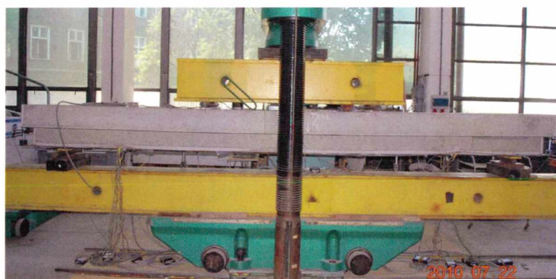
Rys. 4.61 Belka B2S-1 na stanowisku badawczym
