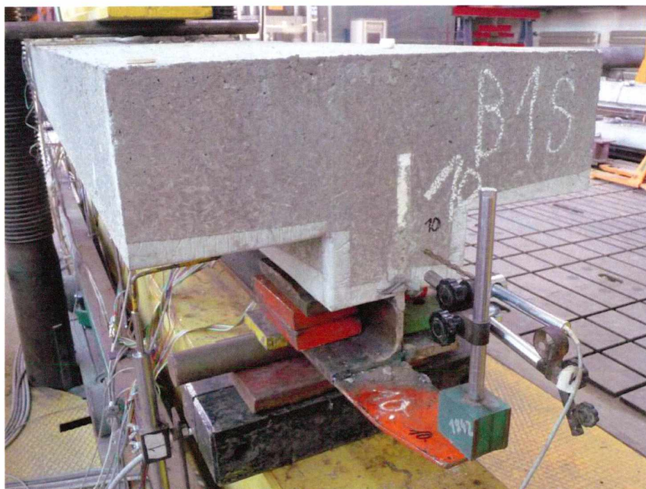
Rys. 4.47 Czujnik indukcyjny poślizgu (nr 10) na końcu belki
