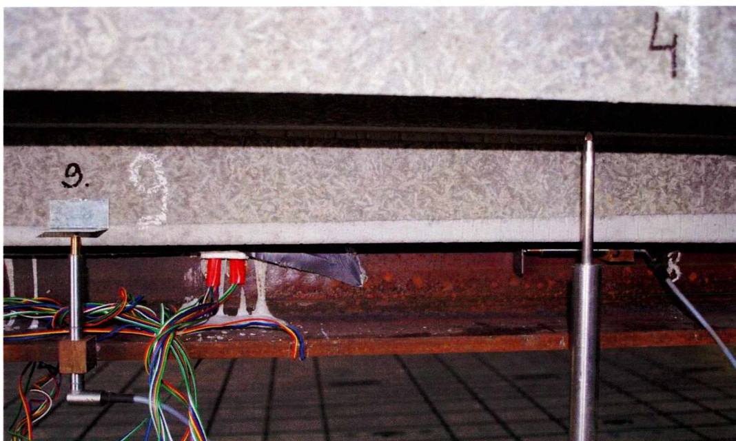
Rys. 4.46 Czujniki indukcyjne: oddzielenia poprzecznego (nr 9), poślizgu w 1/4 L (nr 8) oraz przemieszczenia pionowego belki (nr 4). W tle widoczne okablowanie tensometrów przyklejonych na łącznikach
