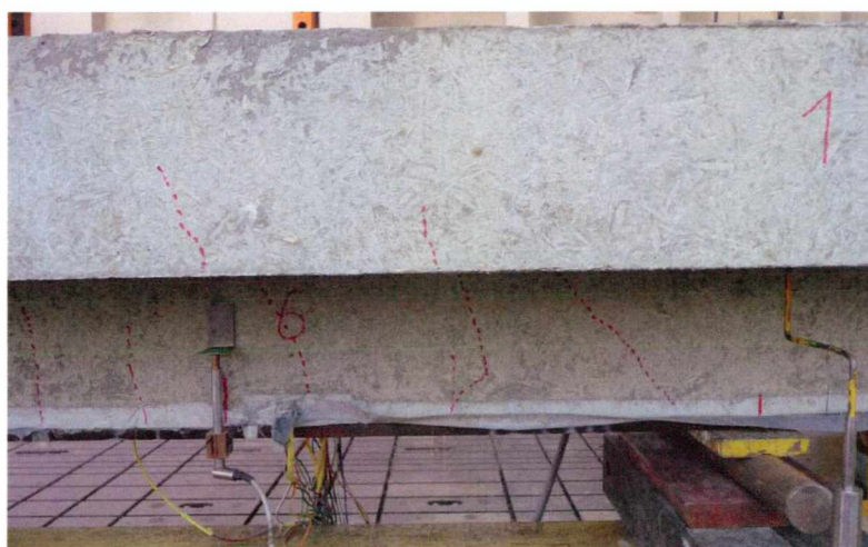
Rys. 4.62 Zasięg rys w środku betonowym podczas 25 cykli obciążenia 55 – 440 kN (pokazano strefę pracujących łączników po stronie najbardziej zarysowanej)
