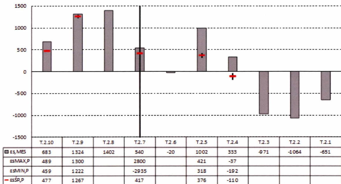
Rys. 5.19 Zbieżność wyników otrzymanych z modeli MES i doświadczenia dla łącznika nr 2 belki B1S-2
