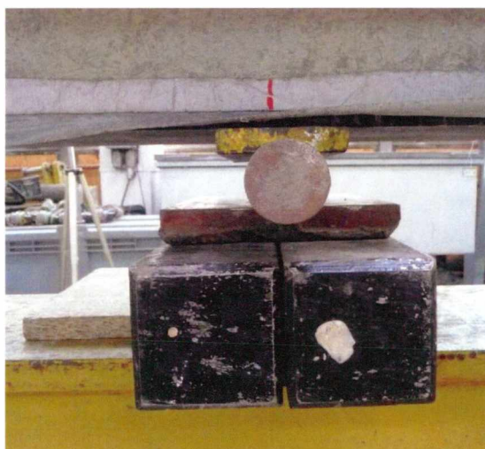
Rys. 4.41 Łożysko potoczyste wałkowe stanowiące oparcie badanych belek
