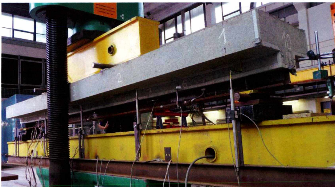
Rys. 4.45 Czujniki indukcyjne przemieszczeń pionowych belki, poślizgów oraz oddzielenia poprzecznego – widok ogólny
