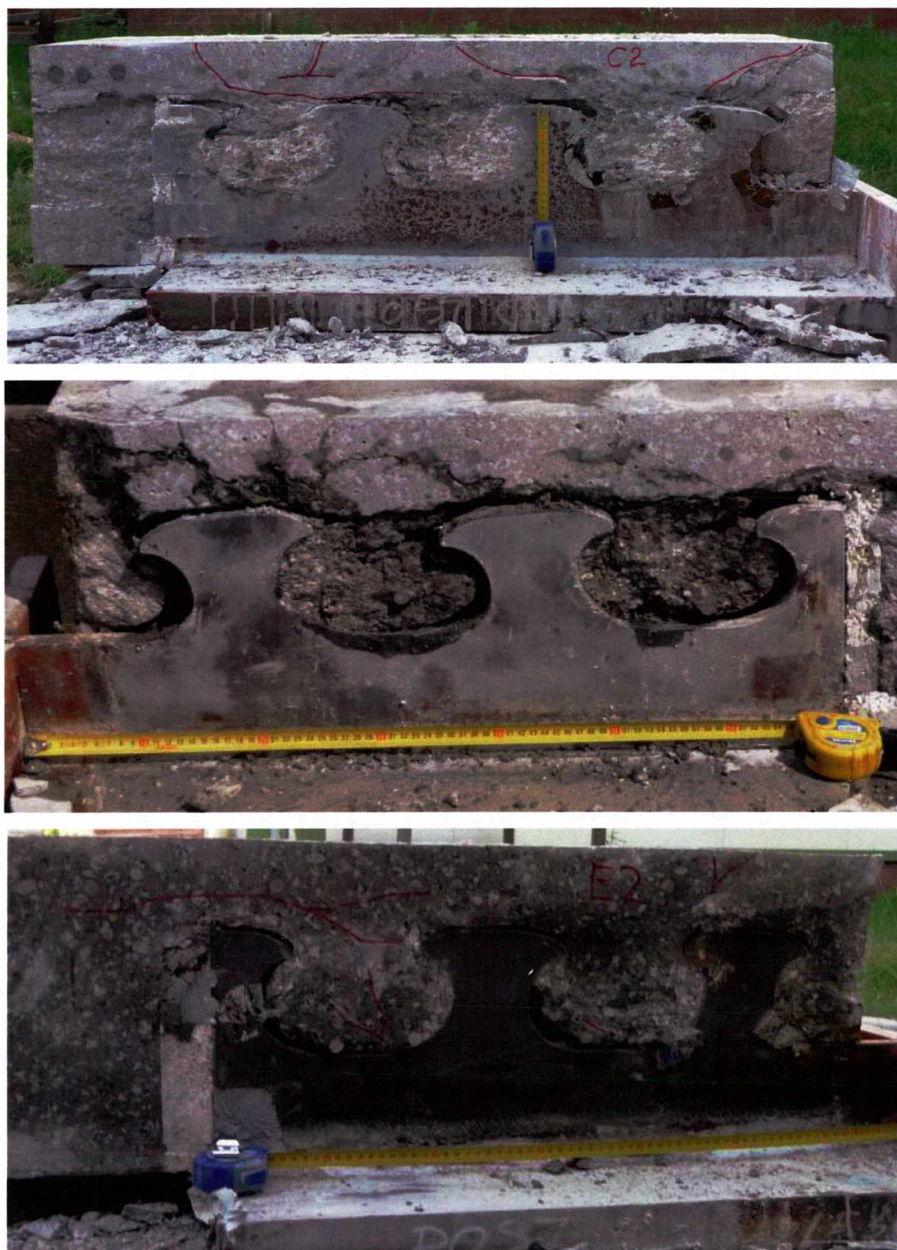
Rys. 4.26 c.d. Elementy POST po ich rozcięciu. Od góry seria C, D i E
