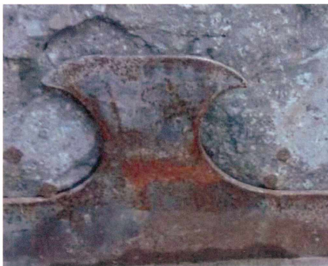
Rys. 4.70 Zdeformowany łącznik stalowy po rozcięciu belki w płaszczyźnie zespolenia
