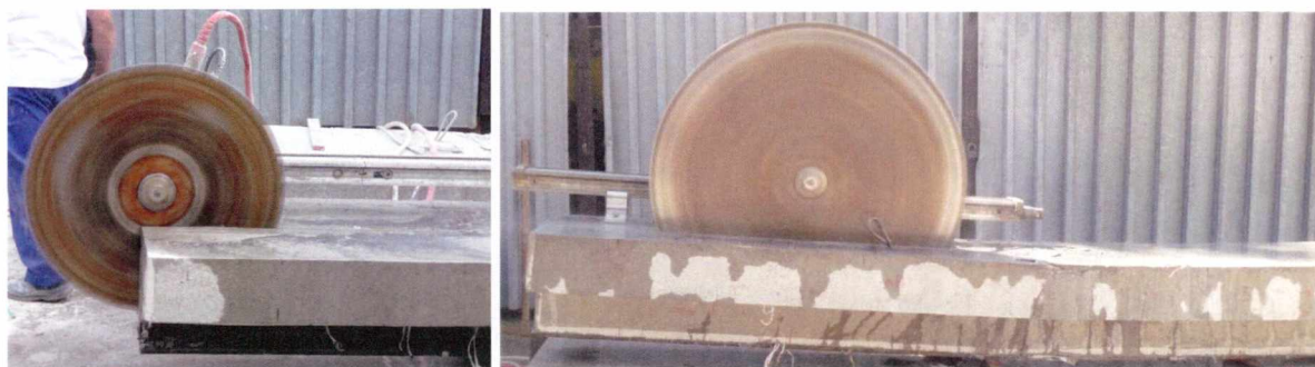
Rys. 4.67 Belka B1S-1 (po lewej) oraz B2S-1 (po prawej) w trakcie rozcinania w płaszczyźnie zespolenia
