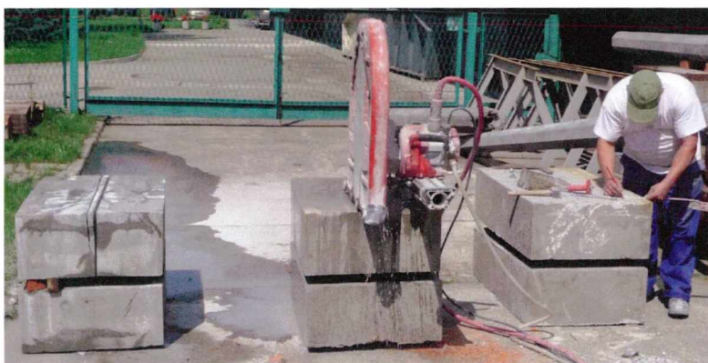
Rys. 4.25 Cięcie elementów POST po przeprowadzonych badaniach niszczących
