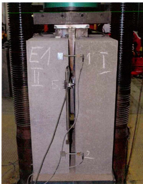
Rys. 4.12 Czujniki indukcyjne do pomiaru oddzielenia poprzecznego oraz poślizgów między częścią stalową i betonową – widok z jednej strony elementu
