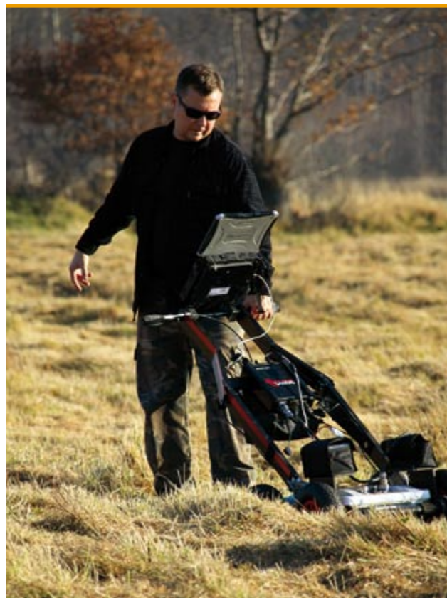
W poszukiwaniach dawnych wyrobisk wykorzystywana jest, oprócz dawnych map i planów, również nowoczesna aparatura badawcza – georadar
