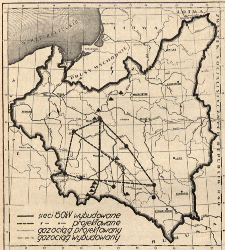
Rys. 9. Sieć krajowa elektryczna i gazowa.
