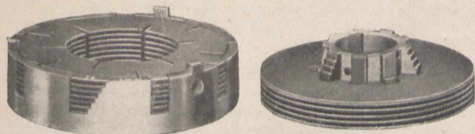
Rys. 5 i 6. Płytki zewnętrzna i wewnętrzna sprzęgła wrzeciona wiertarki promieniowej Raboma.
