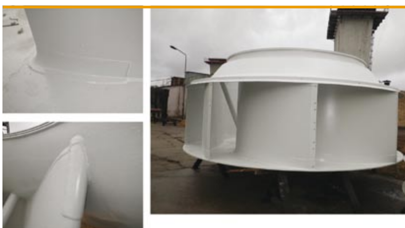
Wirnik wentylatora nowej generacji przygotowany do zabudowy
