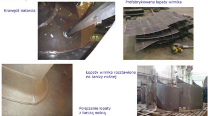
Wykonanie wirnika wentylatora promieniowego nowej generacji
