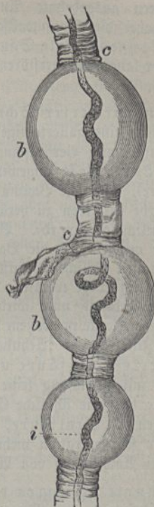
Fig. 9. Baumwolle durch Kupferoxyd-ammonial aufgequell.
