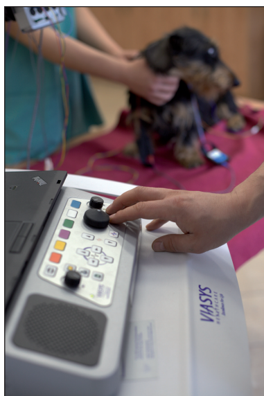
Dr Marcin Wrzosek przeprowadza badanie słuchu psa za pomocą aparatu do diagnostyki elektro-neurologicznej VIKING QUEST
