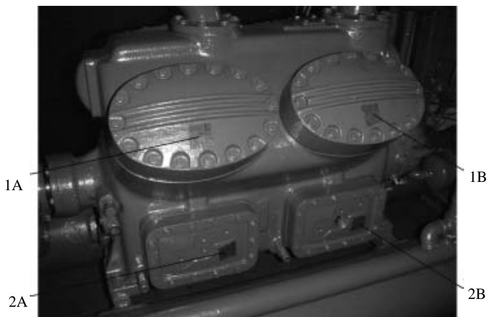
Rys. 13.7. Głowice cylindrowe (1A i 1B) i pokrywy miski olejowej (2A,2B) sprężarki chłodziarki DV-290
