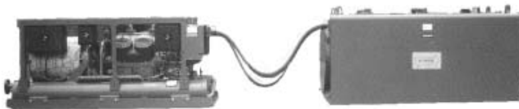
Rys. 8.6. Chłodziarka bezpośredniego działania typu DV-290
