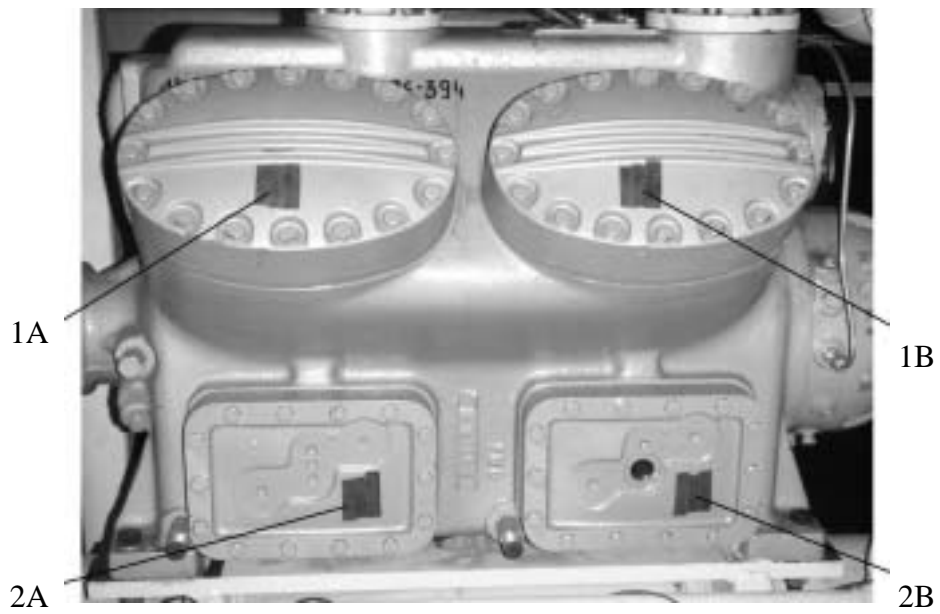
Rys. 13.3. Głowice cylindrowe i pokrywy miski olejowej sprężarki TS-300/1
