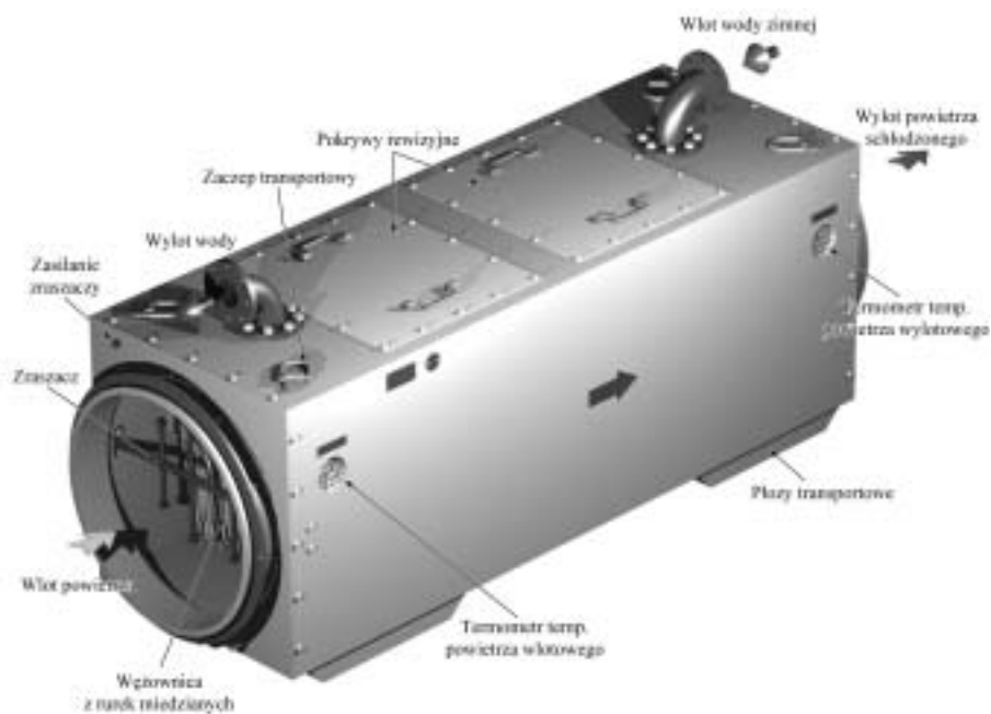
Rys. 8.16. Schemat chłodnicy powietrza typu CP-200
