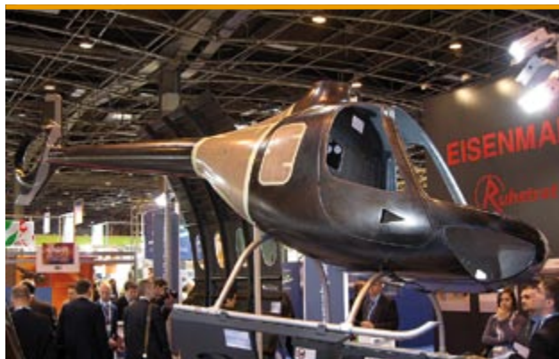
Kadłub małego helikoptera wykonany z kompozytu węglowego
