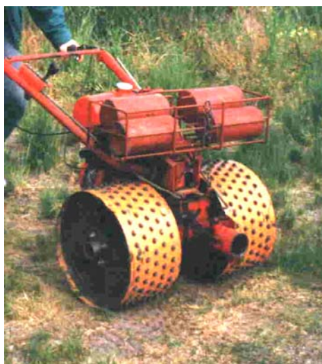
Rys. 1. Urządzenie do kontrolowanego niszczenia (udeptywania) darni
