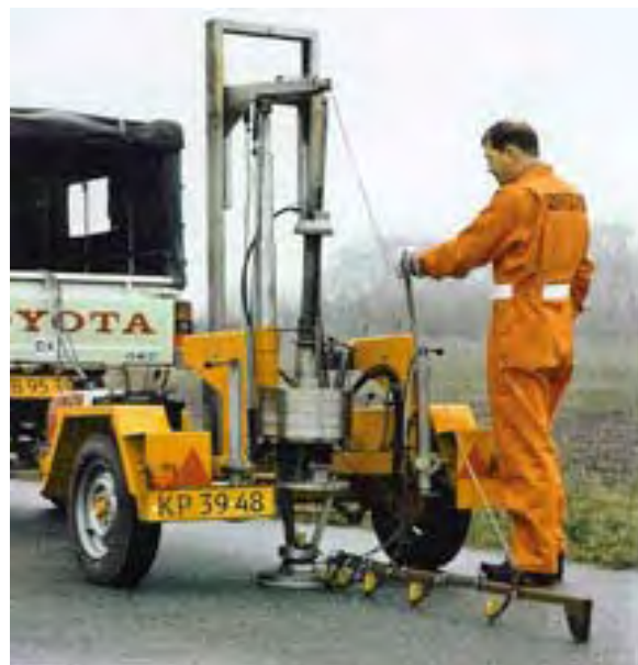
Rys. 4.11. FWD Phoenix ML5000 z 1981r. Zdjęcie zapożyczone z [111]
