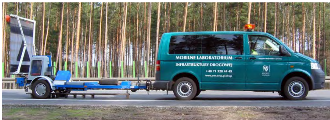
Rys. 3.4. Widok urządzenia FWD 8002 firmy Dynatest
