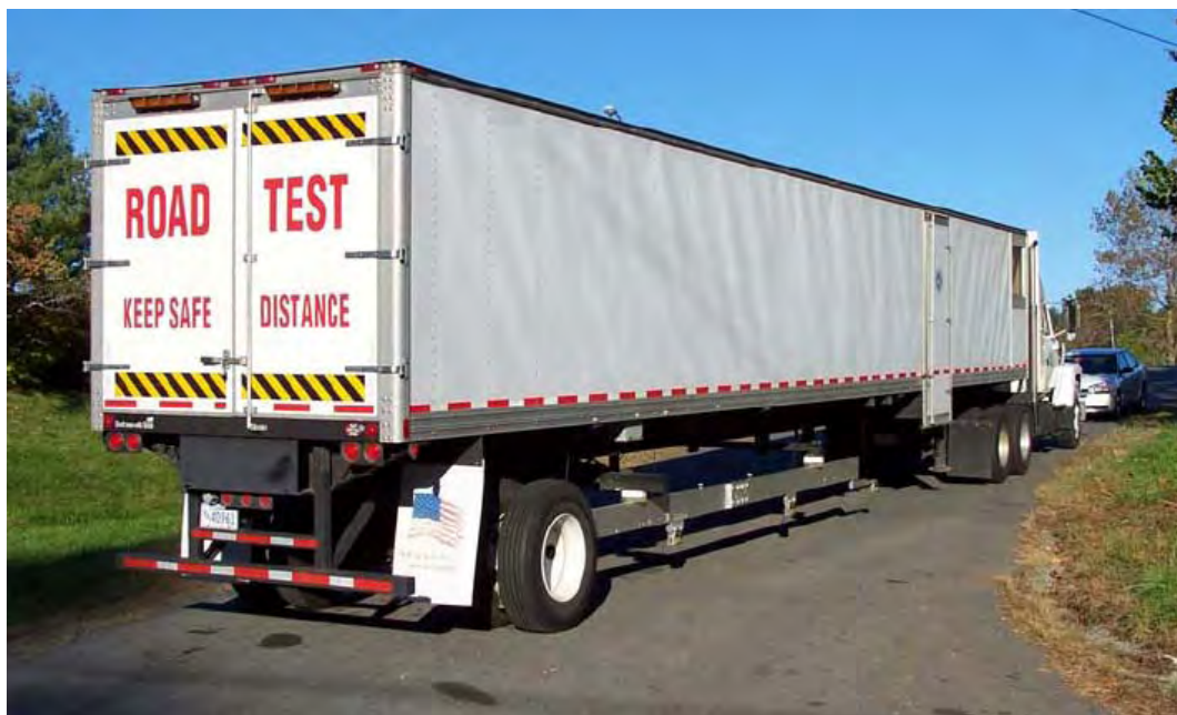
Rys. 3.5. Widok ugięciomierza RWD. Zdjęcie zapożyczzone z [18]
