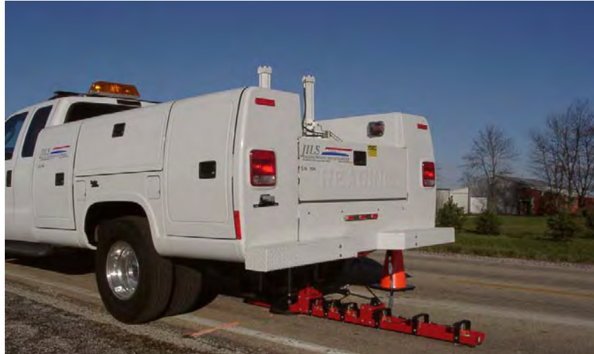
Rys. 4.13. Widok zabudowanego na pojeździe modelu FWD JILS 20T. Zdjęcie zapożyczone z [34]
