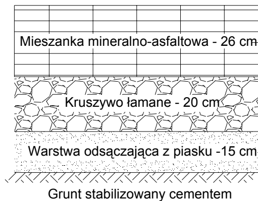
Rys. 5.6. Układ warstw badanej nawierzchni
