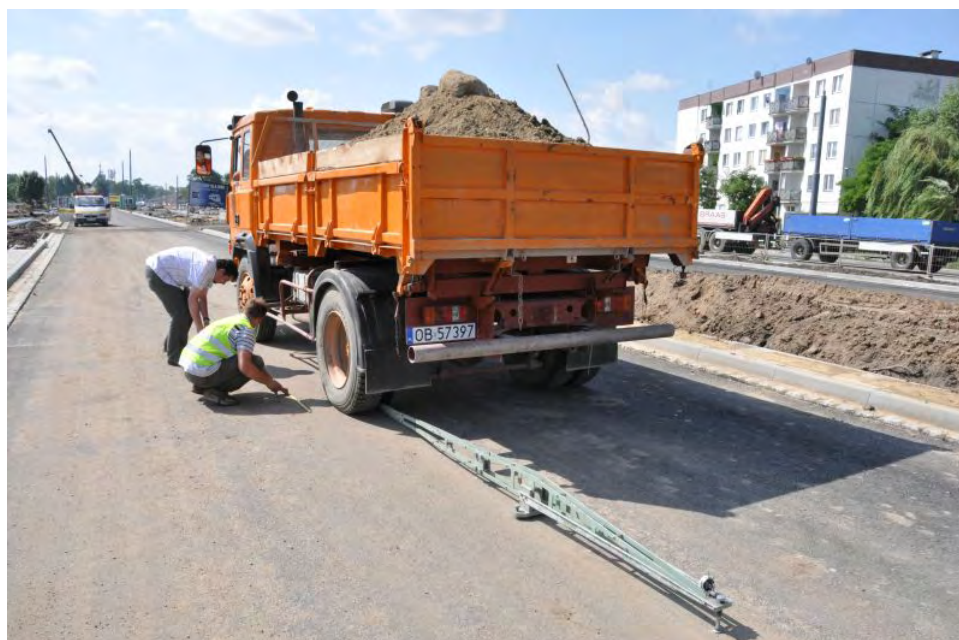
Rys. 3.1. Pomiary ugięć belką Benkelmana na ul. Bardzkiej we Wrocławiu
