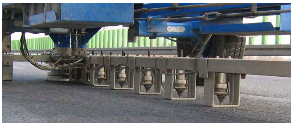
Rys. 4.2. Widok geofonów i płyty naciskowej
