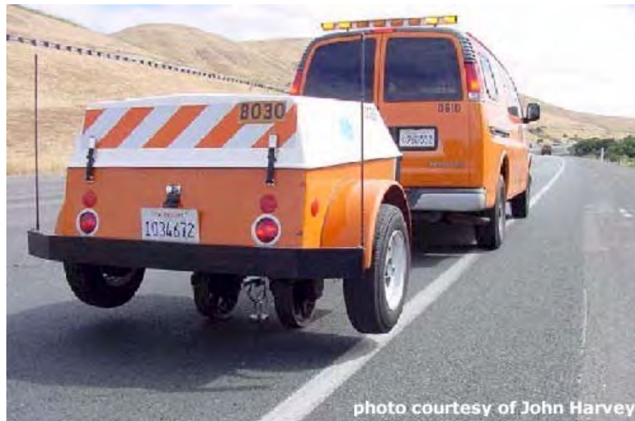
Rys. 3.3. Widok ugięciomierza Dynaflect. Zdjęcie zapożyczzone z [117]
