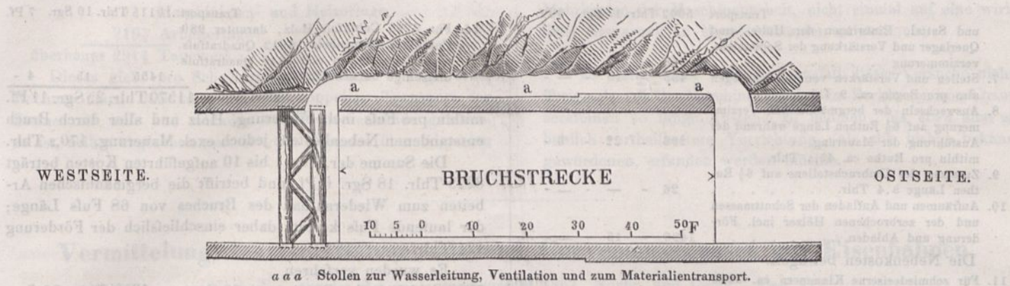
a a a Stollen zur Wasserleitung, Ventilation und zum Materialtransport.
