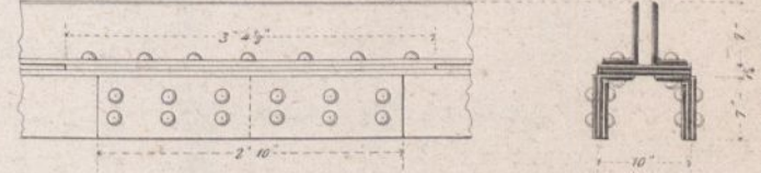
Verlaschung des Winkeleisens in der unteren Gurtung.
