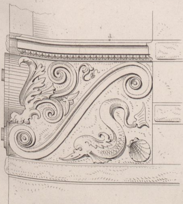
Ecklösung am Kuppelunterbau.
