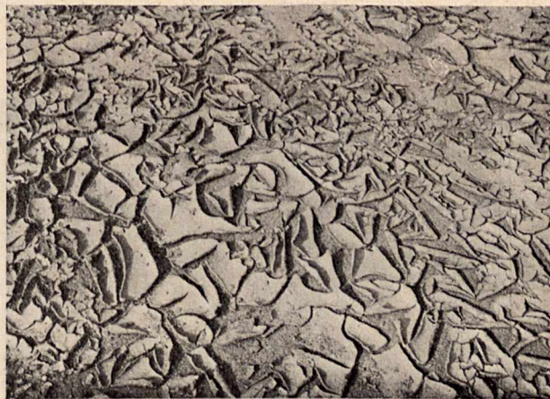
Rys. 1. Zeschnięta skorupa na filtrze wodociągowym.
