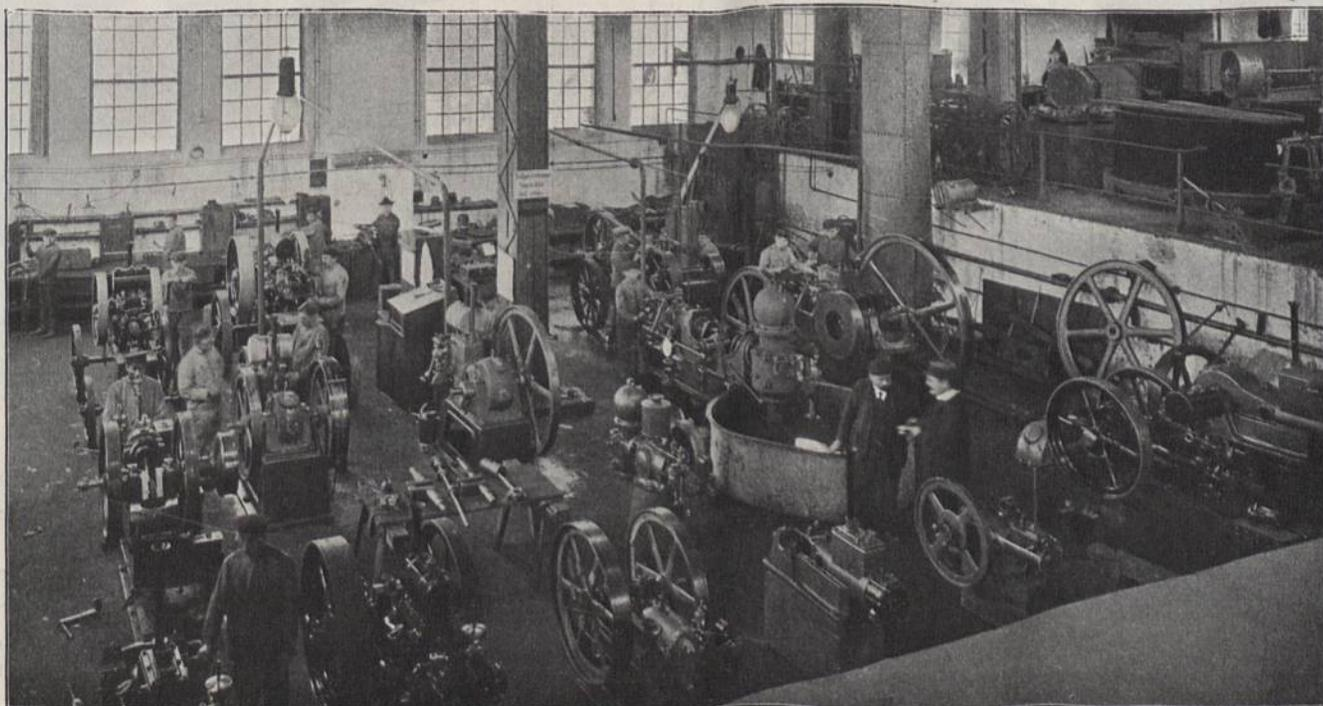
Probierraum für Pumpen und Motoren.
