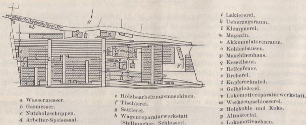
Fig. 5. Lageplan der Hauptwerkstatt Breslau-Freiburg. Zustand vom 1. Januar 1905. 1:5000.
