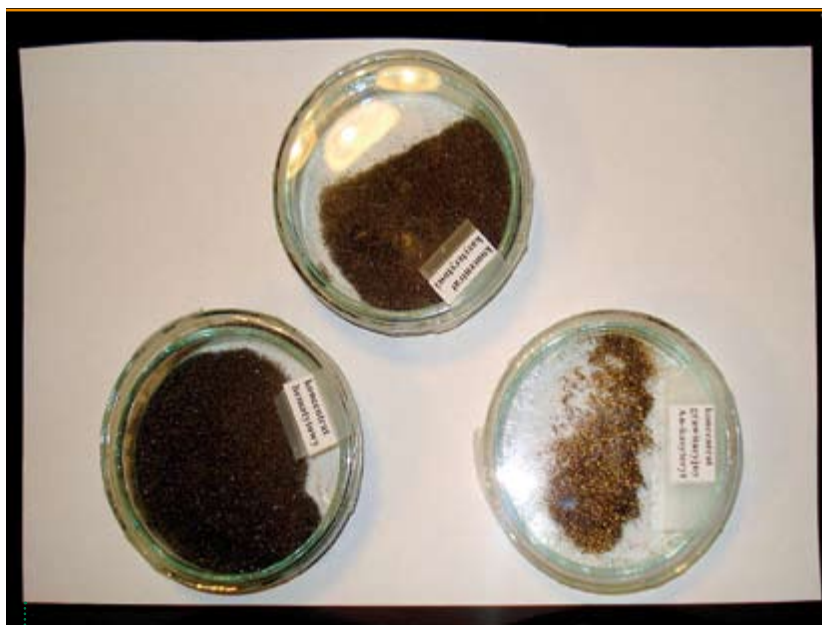
Próbki koncentratów: Au-kasyteryt, hematytowy i kasyterytowy przedstawione przez dr. Antoniego Muszera
