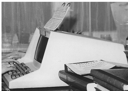
Il. 7. Monitory ekranowe maszyny cyfrowej MERA 9150
