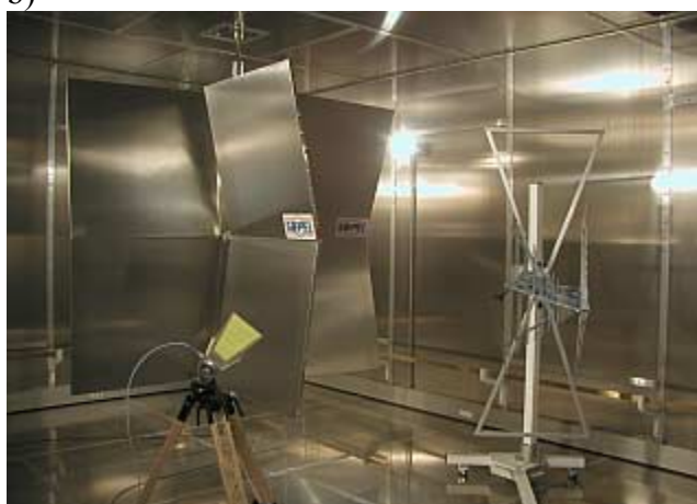
Rys. 2.10. Stanowiska do pomiaru emisyjności urządzeń z wykorzystaniem komory rewerberacyjnej: a), b) Instytut Telekomunikacji, Teleinformatyki i Akustyki Politechniki Wrocławskiej, c) Otto-von-Guericke-University Magdeburg, Niemcy
