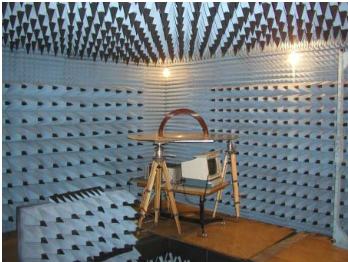
Rys. 7.1. Stanowisko do pomiaru emisyjności urządzeń za pomocą połowy podwójnie obciążonej okrągłej anteny ramowej nad przewodzącą płaszczyzną
