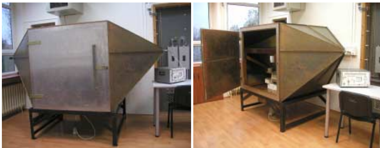
Rys. 2.5. Stanowisko do pomiaru emisyjności urządzeń z wykorzystaniem komory TEM w Instytucie Telekomunikacji, Teleinformatyki i Akustyki Politechniki Wrocławskiej
