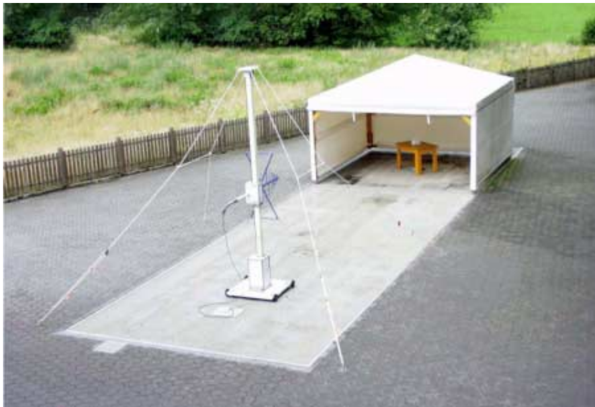
Rys. 2.3. Stanowisko OATS z osłoną przeciwdeszczową w Innovative constructions GmbH - Schfarzenfeld, Germany[ 32]
