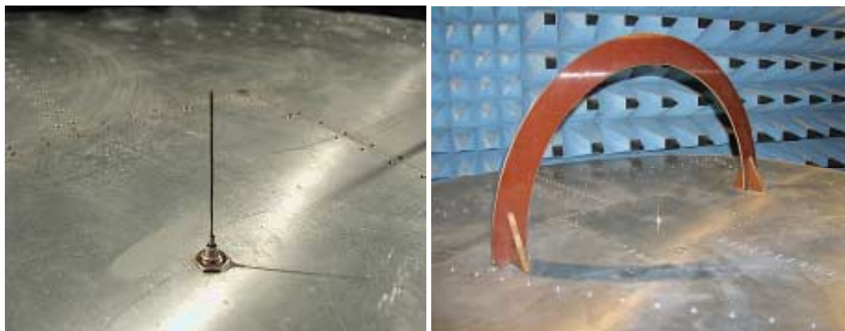
Rys. 7.3. Dipol elektryczny zastosowany w pomiarach kalibracyjnych
