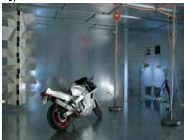
Rys. 2.10. Stanowiska do pomiaru emisyjności urządzeń z wykorzystaniem komory rewerberacyjnej: a), b) Instytut Telekomunikacji, Teleinformatyki i Akustyki Politechniki Wrocławskiej, c) Otto-von-Guericke-University Magdeburg, Niemcy
