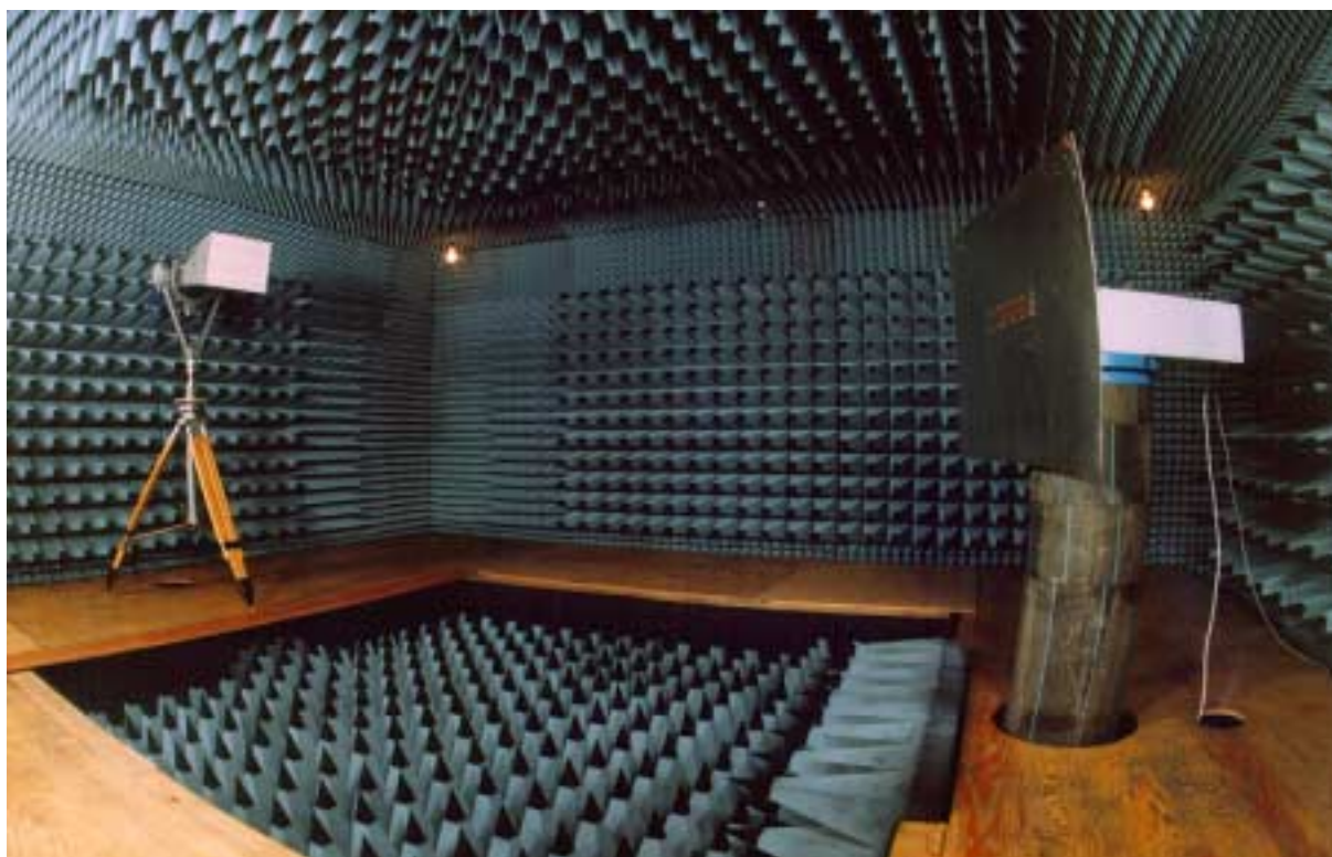
Rys. 2.4. Stanowisko do pomiaru zaburzeń promieniowanych z wykorzystaniem komory bezodbiciowej w Instytucie Telekomunikacji, Teleinformatyki i Akustyki Politechniki Wrocławskiej
