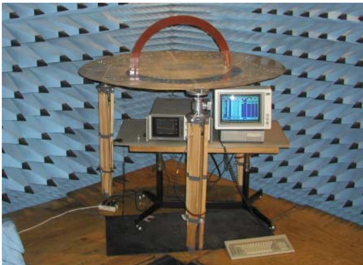
Rys. 2.13. Stanowisko do pomiaru emisyjności urządzeń z wykorzystaniem połowy podwójnie obciążonej okrągłej anteny ramowej umieszczonej prostopadle nad przewodzącą płaszczyzną w Instytucie Telekomunikacji, Teleinformatyki i Akustyki Politechniki Wrocławskiej
