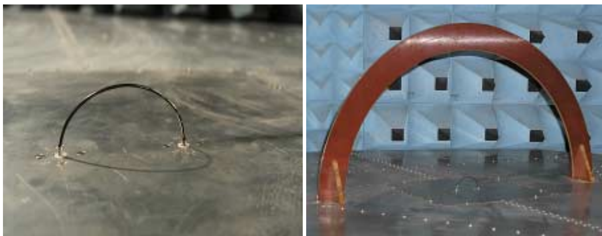
Rys. 7.2. Dipol magnetyczny zastosowany w pomiarach kalibracyjnych
