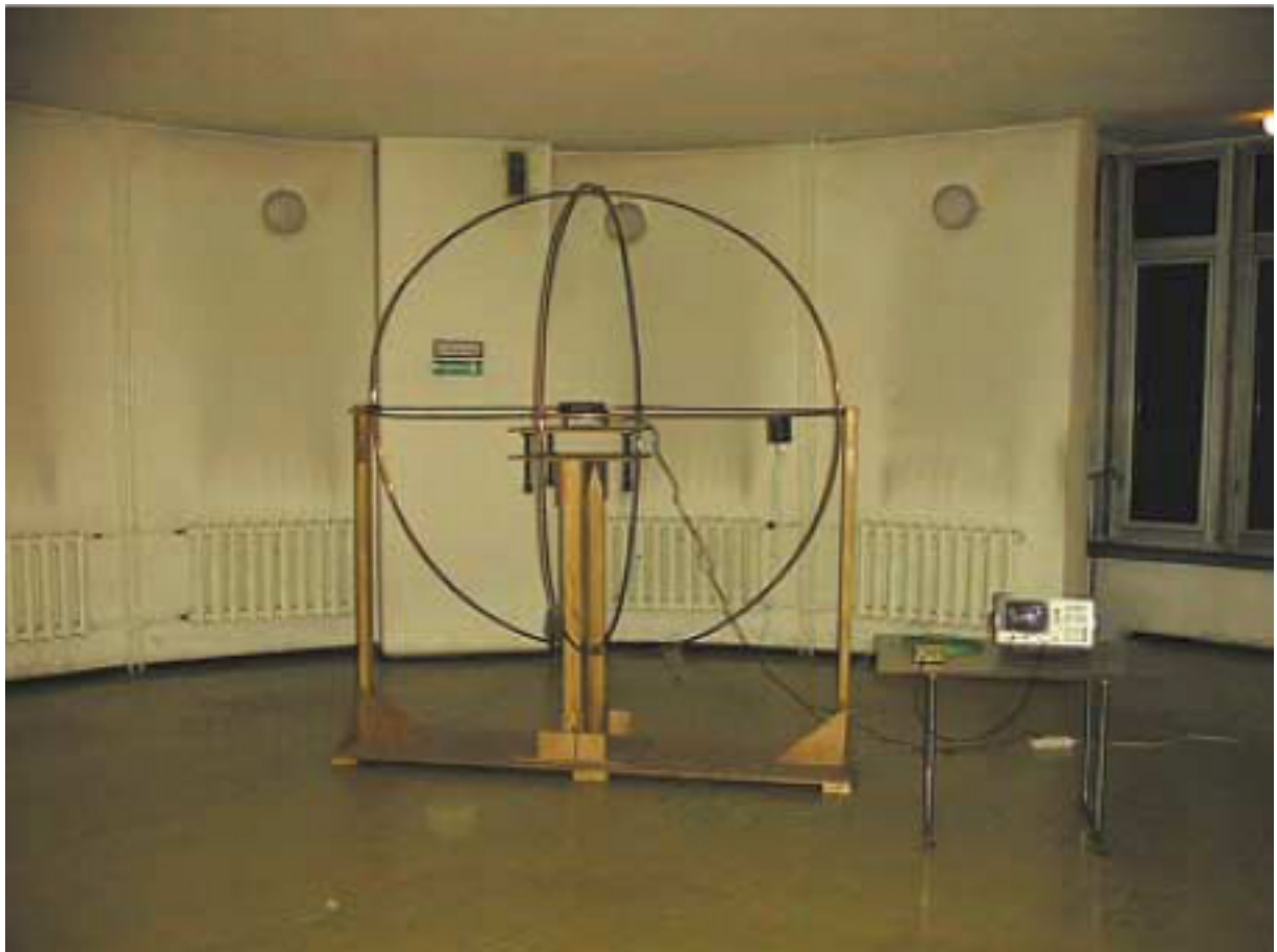
Rys. 2.11. Stanowisko do pomiaru emisyjności urządzeń z wykorzystaniem układu trzech wzajemnie prostopadłych, podwójnie obciążonych anten ramowych w Instytucie Telekomunikacji, Teleinformatyki i Akustyki Politechniki Wrocławskiej
