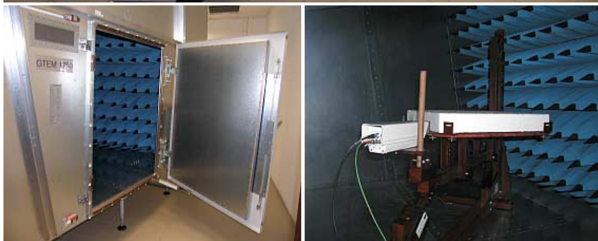
Rys. 2.8. Stanowisko do pomiaru emisyjności urządzeń z wykorzystaniem komory GTEM w Instytucie Telekomunikacji, Teleinformatyki i Akustyki Politechniki Wrocławskiej
