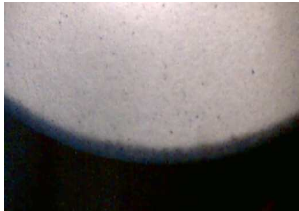
Widok powłoki ceramicznej zaworu ssącego przy powiększeniu x10
