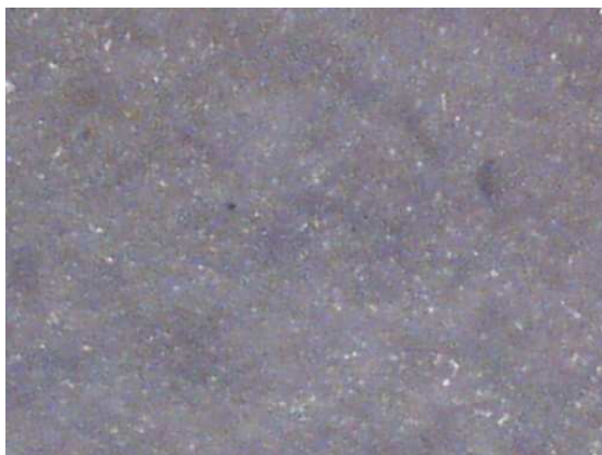
Widok powłoki ceramicznej zaworu wydechowego przy powiększeniu x60
