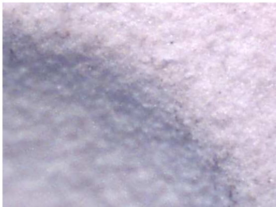
Widok powłoki ceramicznej zaworu wydechowego przy powiększeniu x10
