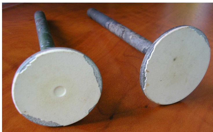
Rys. 7.24. Widok zaworu ssącego i wydechowego z uszkodzoną powłoką ceramiczną
