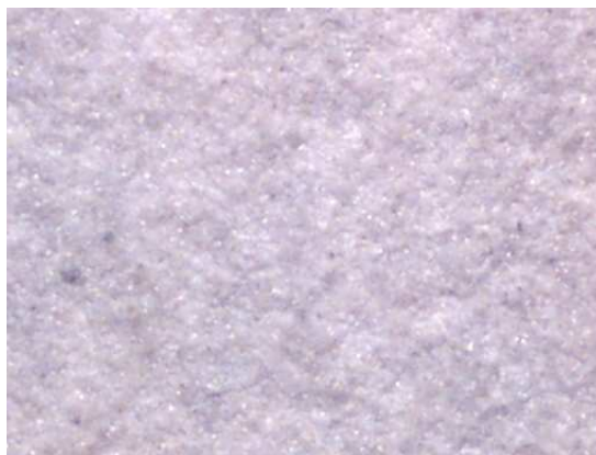
Widok powłoki ceramicznej zaworu wydechowego przy powiększeniu x60
