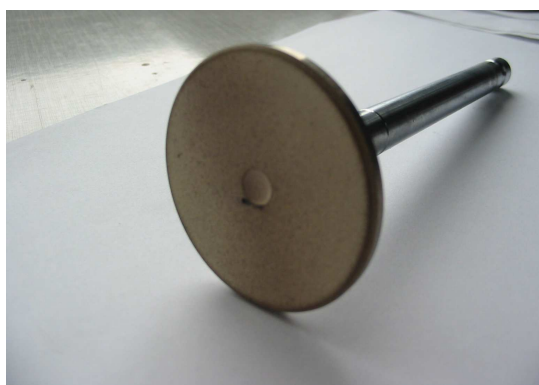
Rys. 7. 18. Widok zaworu ssącego i wydechowego po fazie III
