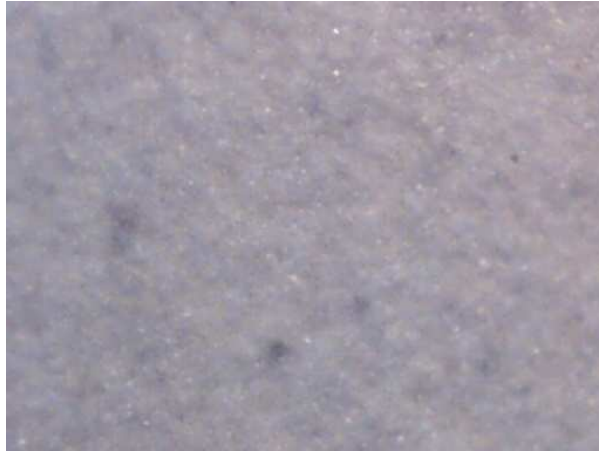
Widok powłoki ceramicznej zaworu ssącego przy powiększeniu x200
