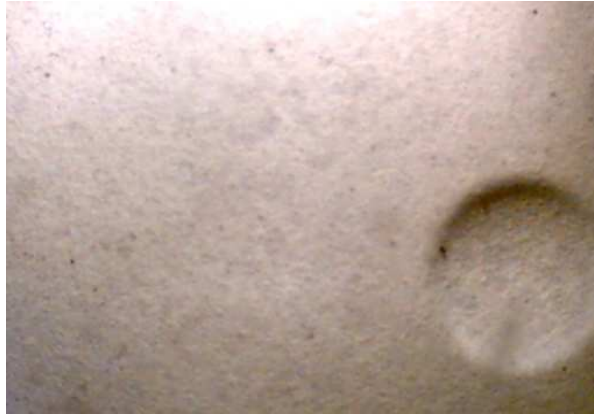
Widok powłoki ceramicznej zaworu ssącego przy powiększeniu x10
