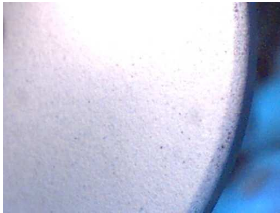
Widok powłoki ceramicznej zaworu wydechowego przy powiększeniu x10
