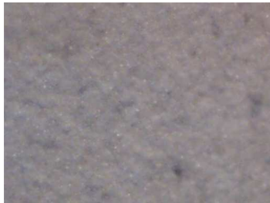
Widok powłoki ceramicznej zaworu wydechowego przy powiększeniu x10
