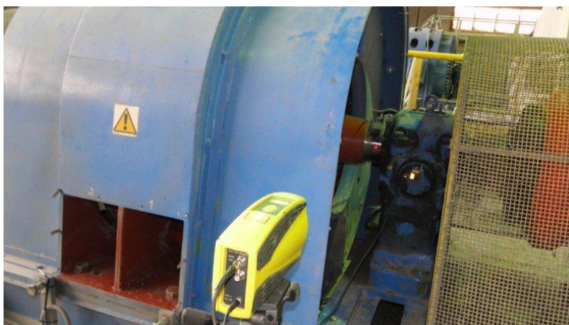
Rys. 12.2. Bezdotykowy pomiar drgań wału napędu młyna (SYUe-148r/01, 1000kW)
