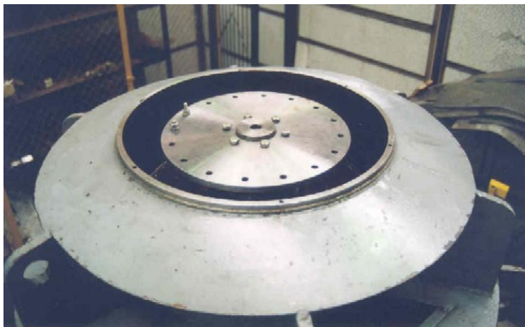
Rys. 11.8. Tarcza korekcyjna do doważania, celowo zamontowana na wirniku silnika
