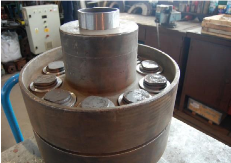
Rys. 11.43. Sprzęgło zespołu wentylatora młynowego z wkładkami pomiarowymi
