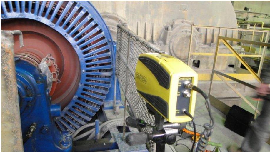
Rys. 12.14. Bezdotykowy pomiar drgań czola uzwojeń stojana SYUe-148r/01, 1000kW
