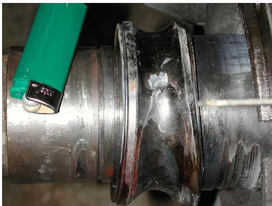
Rys. 3.1 Wytopienie powierzchni pierścienia wewnętrznego łożyska silnika
