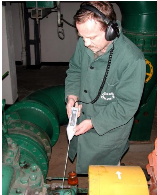
Rys. 9.6. Osłuchiwanie łożysk stetoskopem
