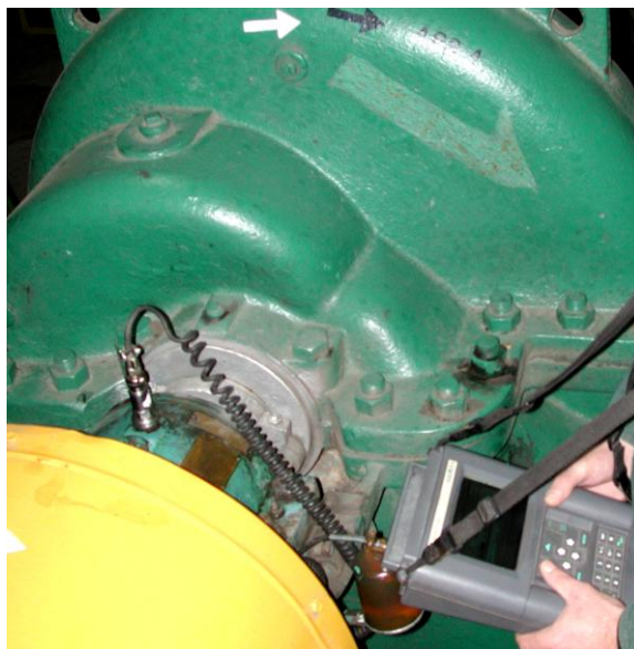
Rys. 8.11. Pomiar drgań z trasy pomiarowej z zastosowaniem zbieracza danych
