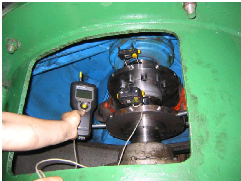
Rys. 11.7. Laserowe osiowanie wałów napędu i pompy
