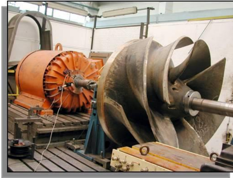
Rys. 4.11. Wyważanie wirnika pompy na quasi-stacjonarnej wyważarce
