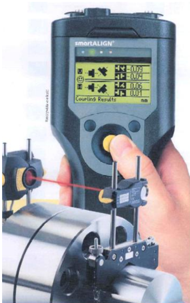
Rys. 10.12. Przykładowy zestaw laserowy stosowany do osiowania wałów ze-sprzęglonych maszyn
