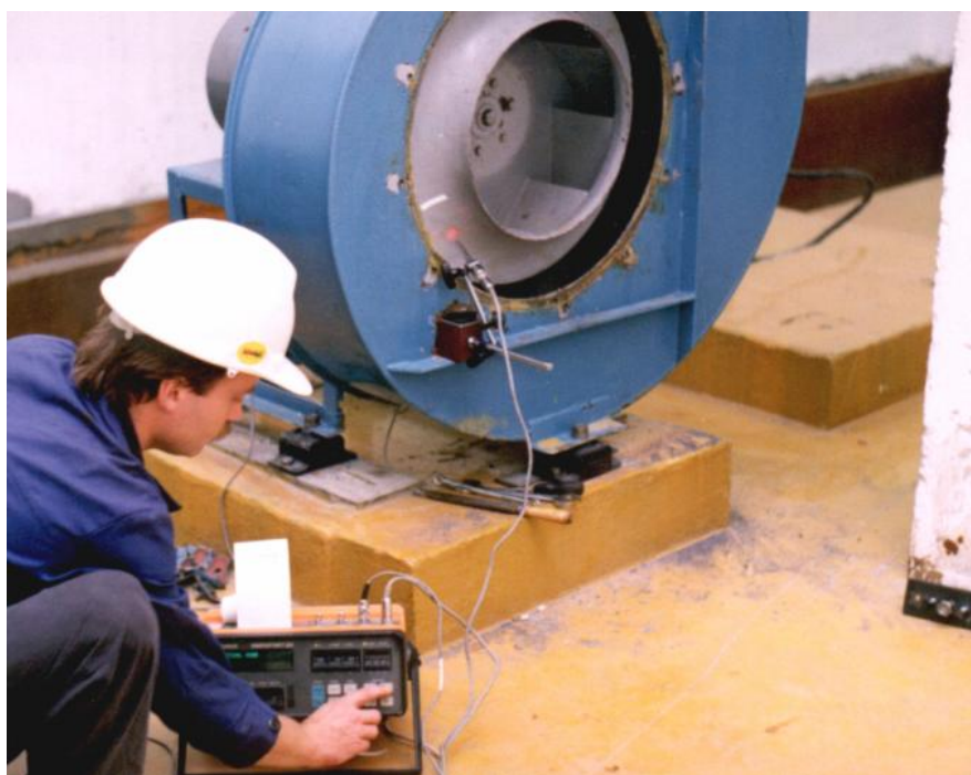
Rys. 10.1. Wyważanie wirnika wentylatora w łożyskach własnych
