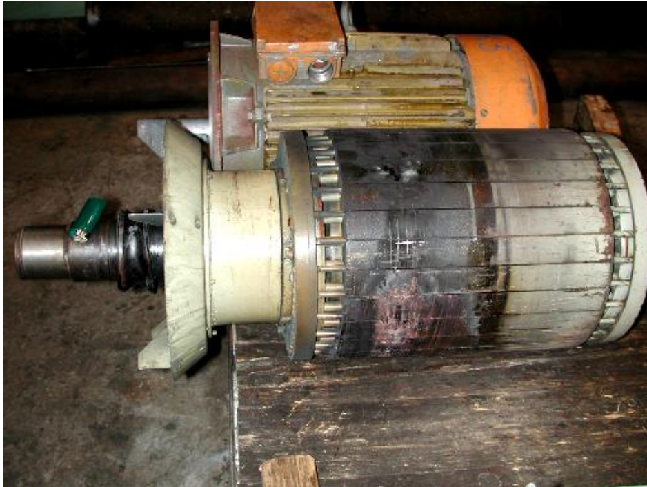
Rys. 3.2. Uszkodzenie wirnika silnika na skutek wytopienia powierzchni pierścienia wewnętrznego łożyska silnika
