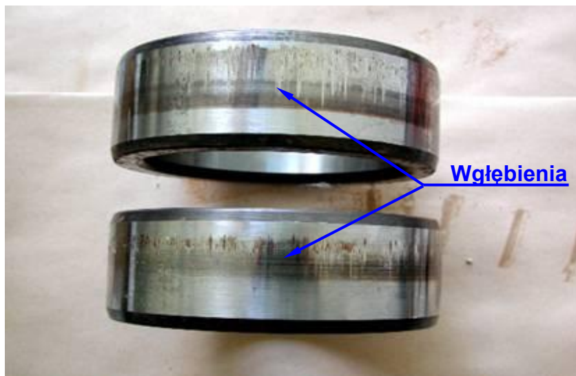
Rys. 11.5. Wgłębienia na bieżni pierścienia wewnętrznego łożyska NU 324C3 silnika posadowionego pionowo spowodowane przeniesieniem drgań z pracującej maszyny sąsiedniej w czasie jego postoju
