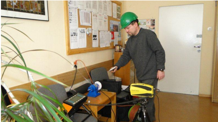
Rys. 12.22. Pobudzenie do drgań silnika w warunkach laboratoryjnych i rejestracja odpowiedzi układu przy pomocy wibrometru laserowego
