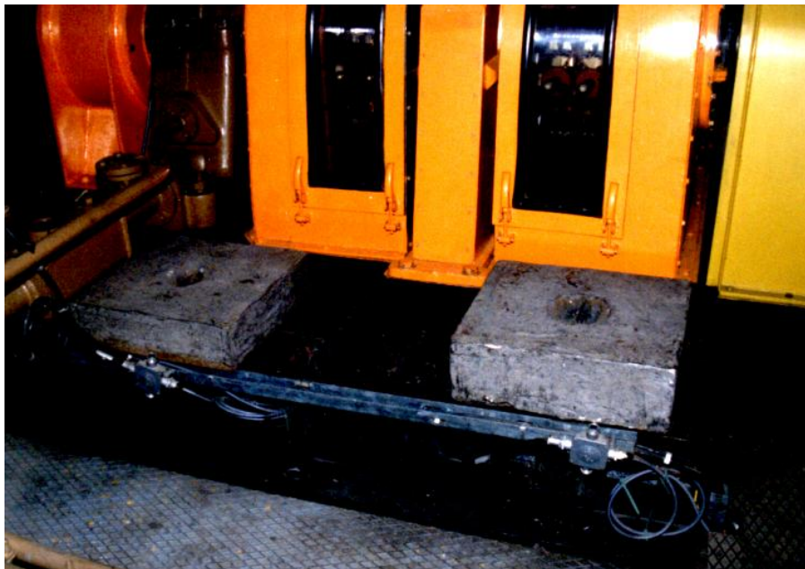
Rys. 3.13. Płyta posadowcza stojaka łożyska wraz z umieszczonymi na niej masami.
