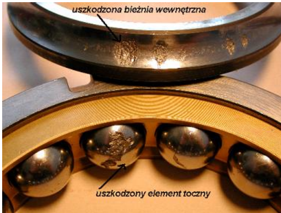
Rys. 3.4. Uszkodzone łożysko pompy cyrkulacyjnej na odsiarczaniu spalin
