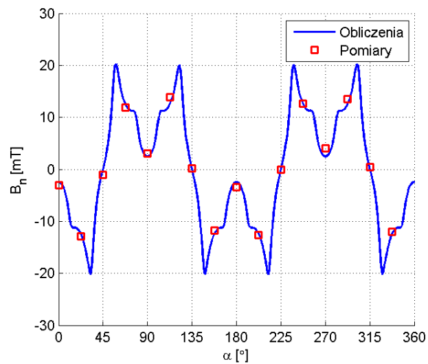
Rys. 7.13. Przebieg składowej B_n indukcji magnetycznej wzdłuż linii pomiarowej przy zasilaniu wszystkich uzwojeń silownika 8-biegunowego prądem o wartości 3 A
