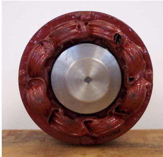
Rys. 7.3. Model fizyczny 8-biegunowego siłownika łożyska magnetycznego
