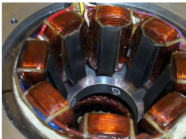
Rys. 1.6. Konstrukcja łożyska promieniowo-osiowego [144]
