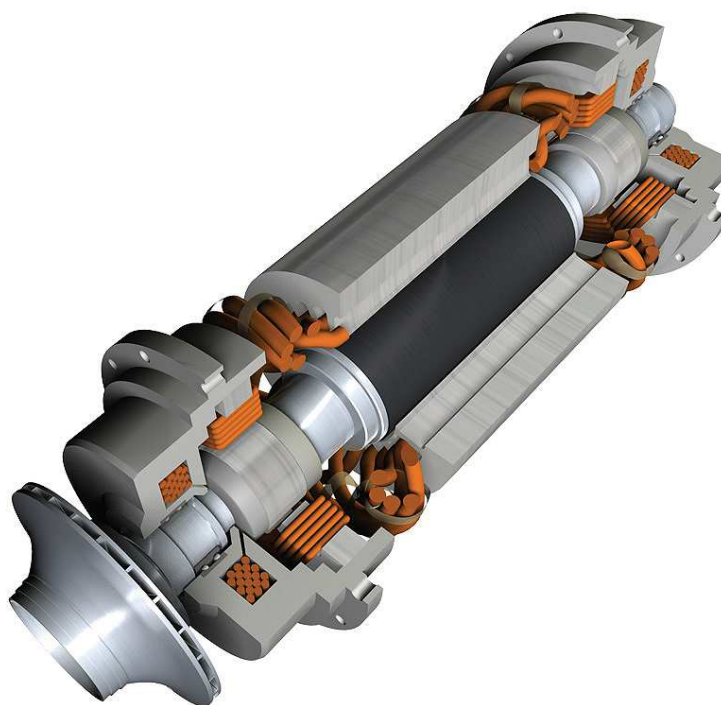
Rys. 1.3. Przekrój turbokompresora łożyskowanego magnetycznie [142]
