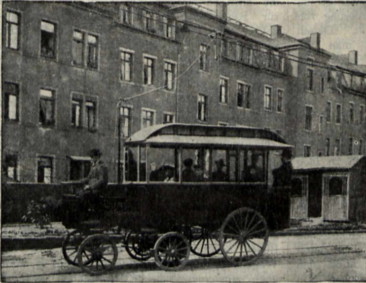
Omnibus mit elektrischem Oberleitungsbetrieb: Wagen für 12 Sitz- und 4 Perronplätze mit freiem Führersitz.
